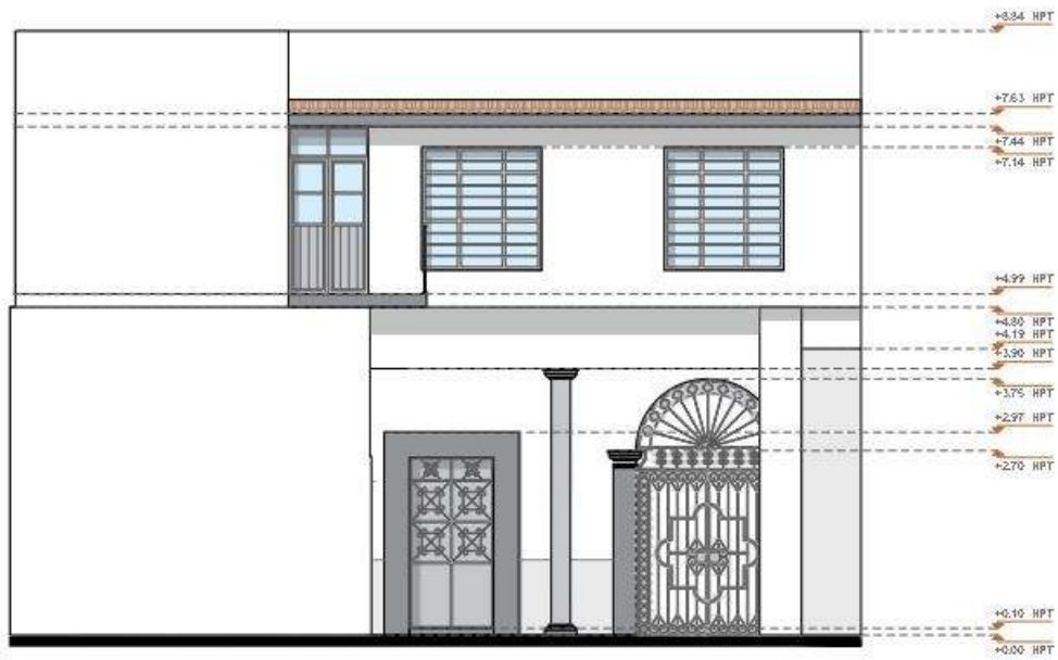
FACHADA INTERIOR 01 Esc. 1:100
