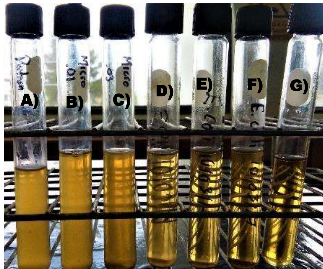
Figura 7.24. Determinación de la sensibilidad y la dosis para la eliminación de E. coli frente a \text{CeO}_2\text{-Ag} 1.5\% -S a CMLs de: A) patrón, B) 1 \times 10^{-3} , C) 3 \times 10^{-3} , D) 5 \times 10^{-3} , E) 7 \times 10^{-3} , F) 9 \times 10^{-3} (g/mL) y G) patrón sin inóculo.
