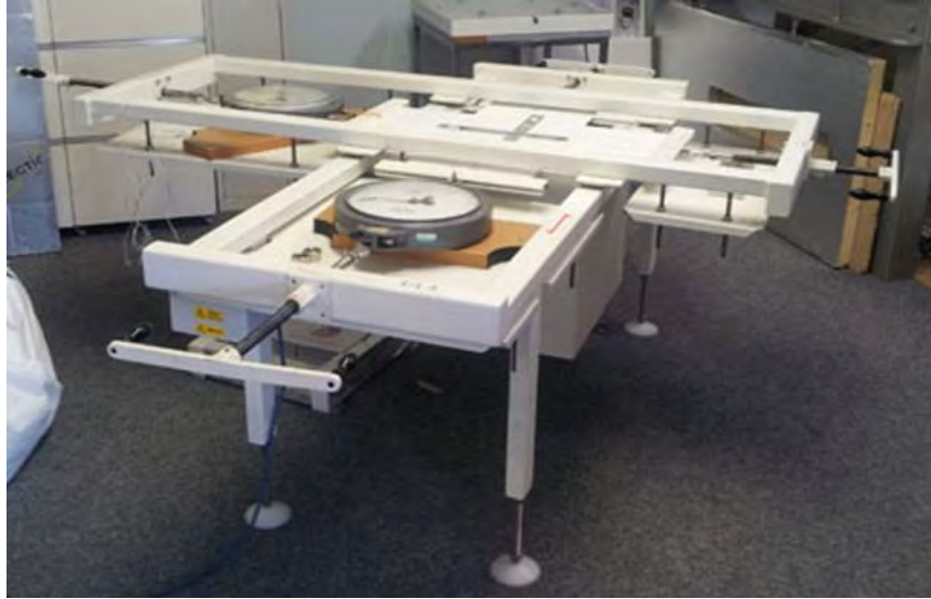
Figura 5 Máquina de ensayo biaxial de marco flotante[3].
