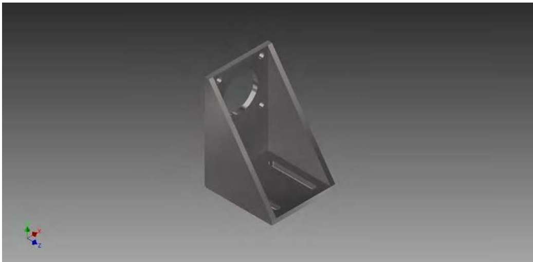
Figura 7 Soportes de motores.
