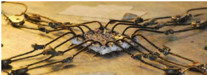
Figura 20 Sujeción de probeta por medio de ganchos metálicos [25].
