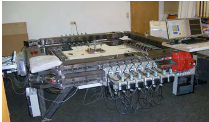
Figura 4 Maquina de ensayo biaxial en base a servomotores[3].
