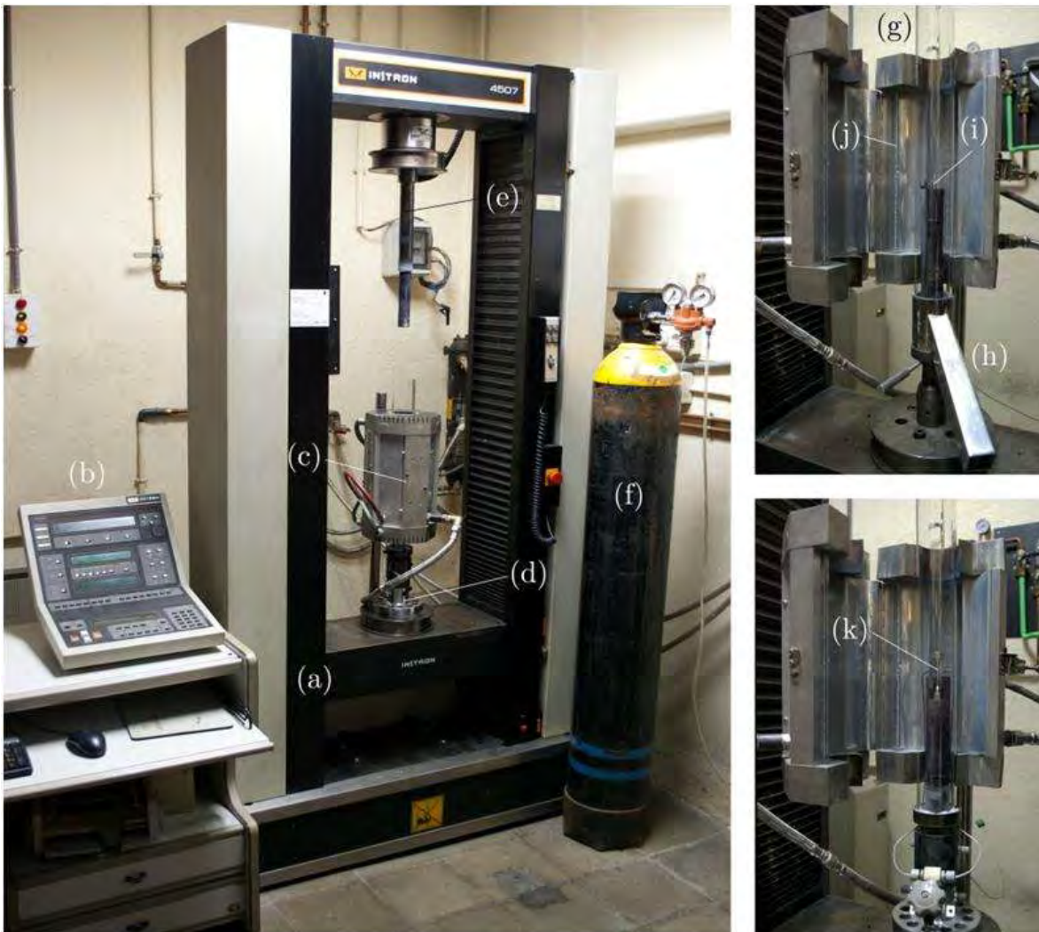
Figura 2.5: (a) Máquina universal de ensayos mecánicos INSTRON 4507 , (b) consola de control, (c) horno de radiación E4 Quad Elliptical Heating Chamber , (d) y (e) mordazas de TZM-VAC , (f) tanque de suministro de Ar, (g) tubo de cuarzo, (h) sistema de temple, (i) probeta de compresión, (j) lámparas infrarrojas y (k) probeta de tracción.
