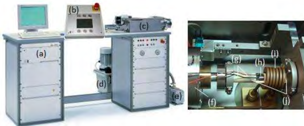
Figura 2.10 Equipo utilizado para la realización de los ensayos de relajación de tensiones: (a) componentes electrónicos, (b) consola, (c) cámara de ensayos, (d) sistema hidráulico, (e) bomba de vacío, (f) unidad de deformación, (g) termopares, (h) probeta de relajación de esfuerzos, (i) bobina de inducción y (j) mordazas.
