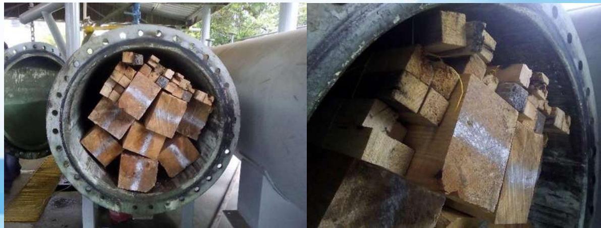
Figura 91. Impregnación de muestras con sales CCA con autoclave.
