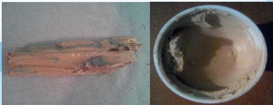
Figura 93. Tratamiento con resina epóxica
