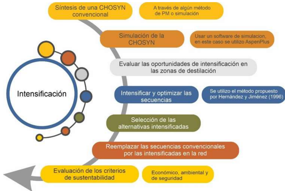
Figura 6.1. Secuencia del método propuesto para intensificar las zonas de destilación de la red.
