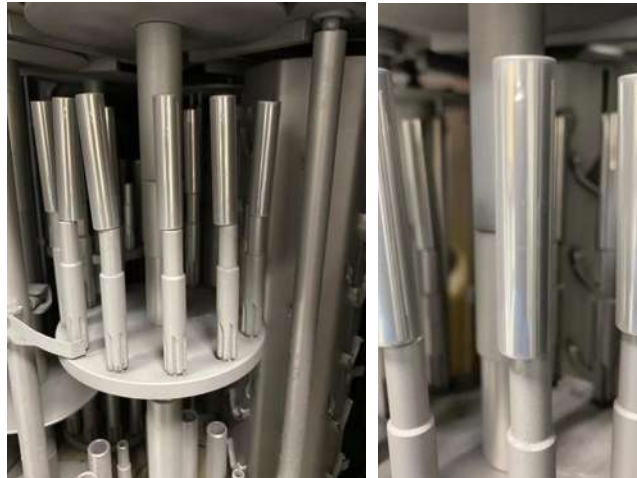
Figura IV.2 Recubrimientos PVD en atmósfera de 400 sccm de Ar y 100 sccm de O 2
