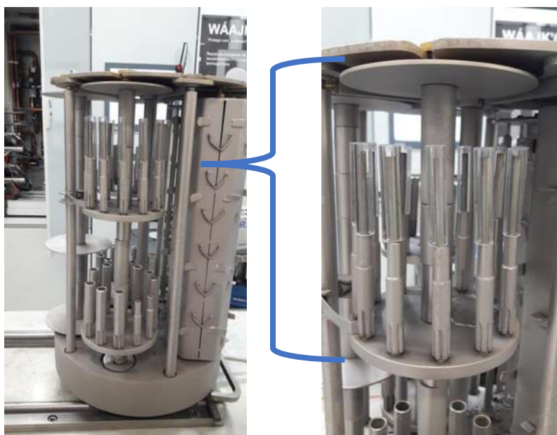
Figura III.3 Montaje de los anillos raschig sobre el soporte giratorio
