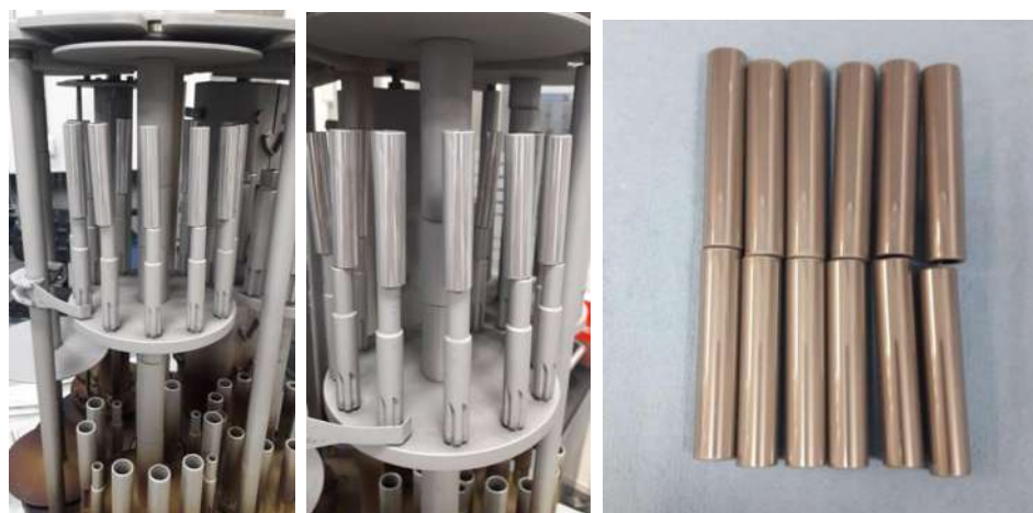
Figura IV.1 Recubrimientos PVD en atmósfera de 440 sccm de Ar y 60 sccm de O_2
