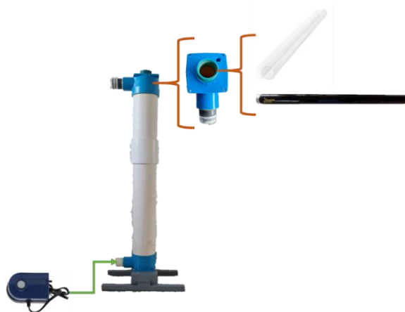
Figura III.11 Reactor con tapa superior donde se sujetarán los hilos de nylon con los anillos raschig, tubo de cuarzo y lámpara UV TecnoLite F20T8BLB
