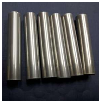
Figura IV.3 Recubrimientos PVD en atmósfera de 300 sccm de Ar y 100 sccm de O 2
