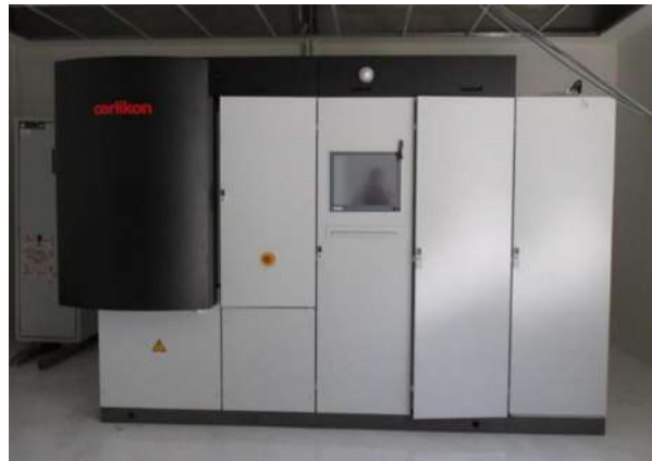
Figura III.5 Equipo PVD marca DOMINO Mini de OERLIKON.
