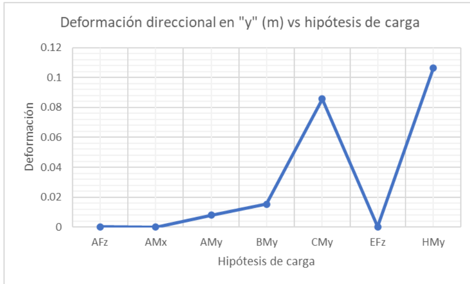
Gráfica 6.3 Deformación direccional del aspa en el eje “y” vs hipótesis de carga.
