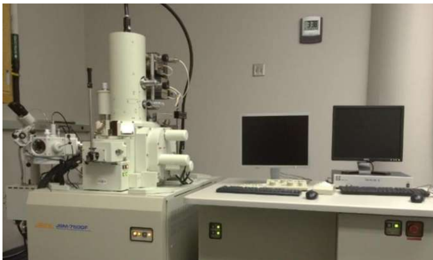
Figura 3.5 Microscopio Electrónico de barrido JEOL JSM-7600F.
