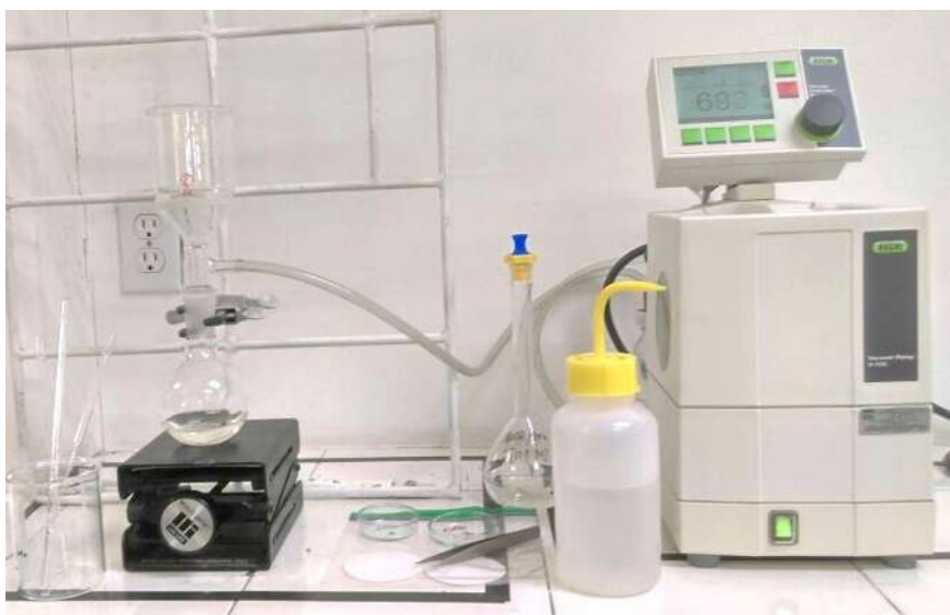
Figura 4.2 Equipo de filtración al vacío para análisis de solubilidad
