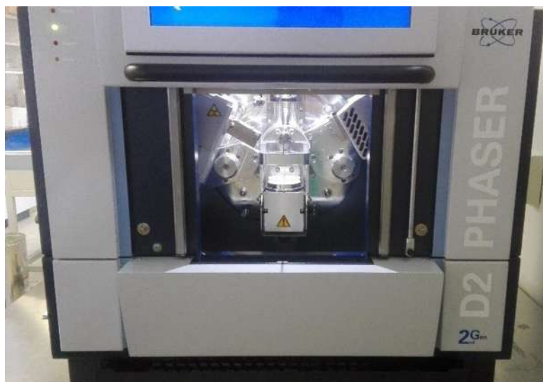
Figura 3.7 Difractómetro D2 Phaser Bruker.
