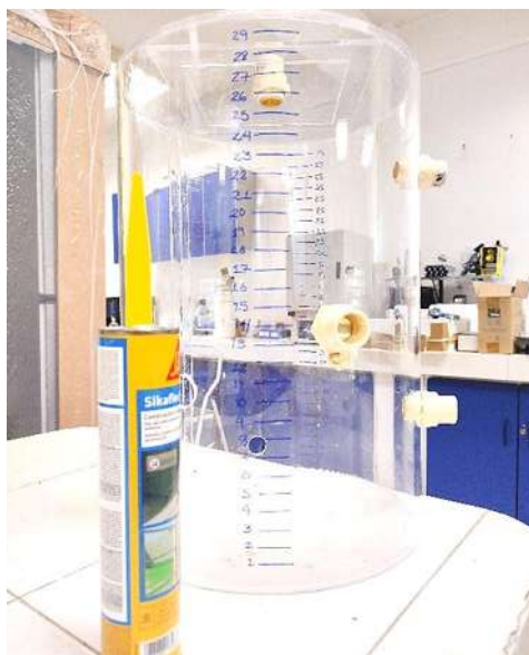
Figura 7. Prototipo del reactor anaerobio de tipo UASB.
