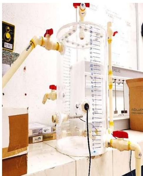
Figura 8. Reactor anaerobio tipo UASB.
