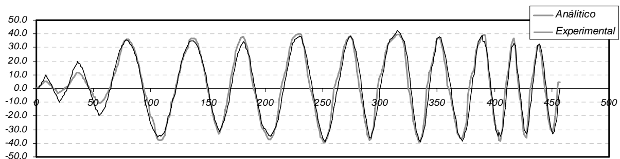
Figura 4.4. Comparación de la historia de desplazamientos experimental y analítica en el primer nivel del modelo 3D.
