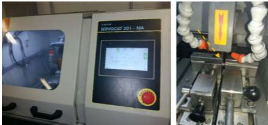
Figura 4.10. Corte de segmento del Inconel 718.
