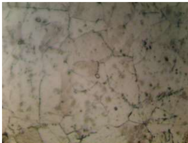
Figura 5.5. Probeta de I-718 atacada 90 segundos 1000x.
