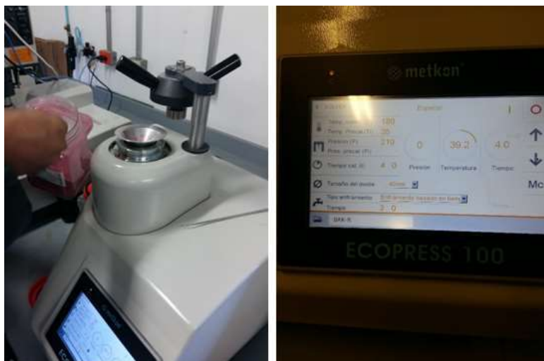
Figura 4.11. Equipo y condiciones utilizado para el montaje de muestra.
