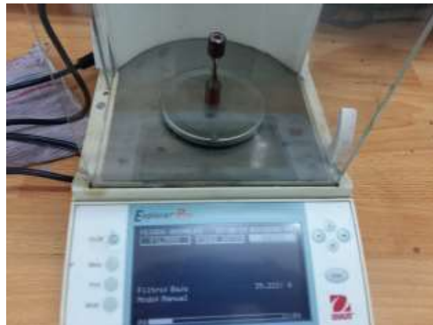
Figura 5.25. Pesaje de las probetas antes-después de estar inmersa en la solución de NaCl.
