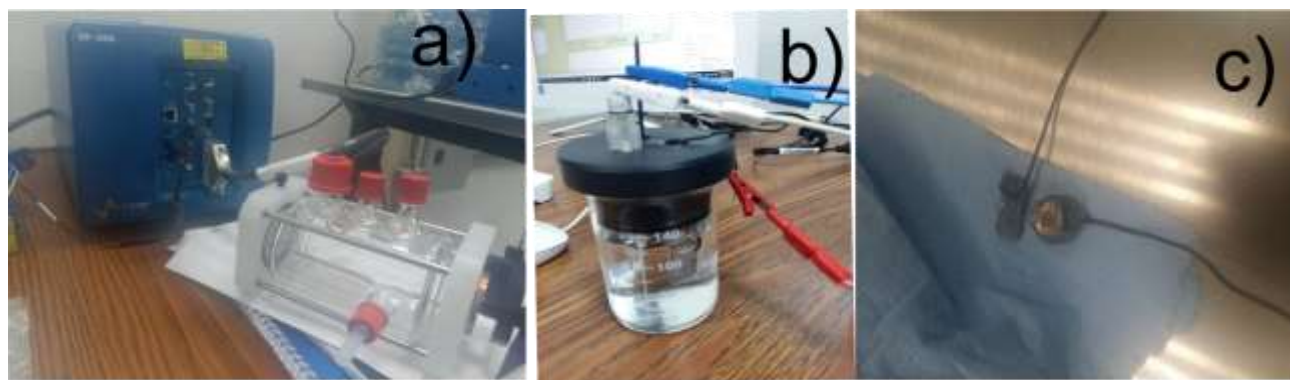
Figura 4.26. Equipo de caracterización electroquímica a), celda de carga para ensayos EIE y Tafel b), muestras del I-718 y AISI 418 c).
