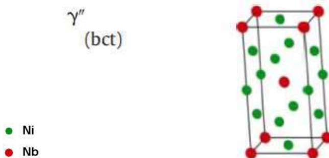
Figura 3.5. Estructura cristalina TCB de la fase cristalina \gamma'' .
