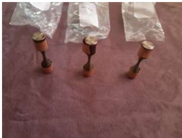
Figura 5.26. Preparación de las probetas para visualización en MEB.
