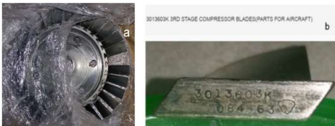
Figura 3.11. Disco y álabes de la turbina J33-Allison a) y número de parte del álabes b).
