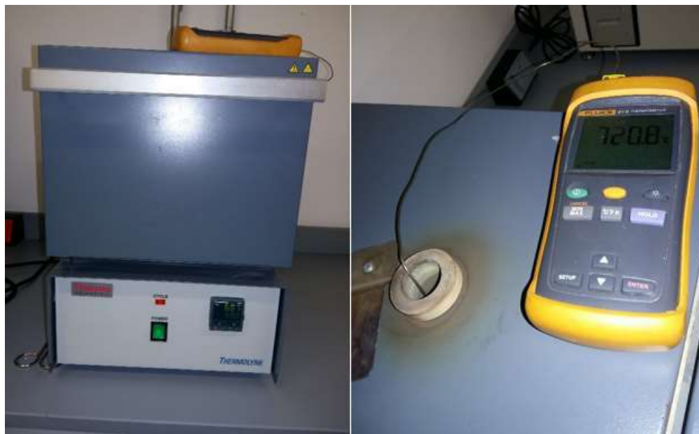
Figura 4.14. Monitoreo de temperatura de los tratamientos térmicos.
