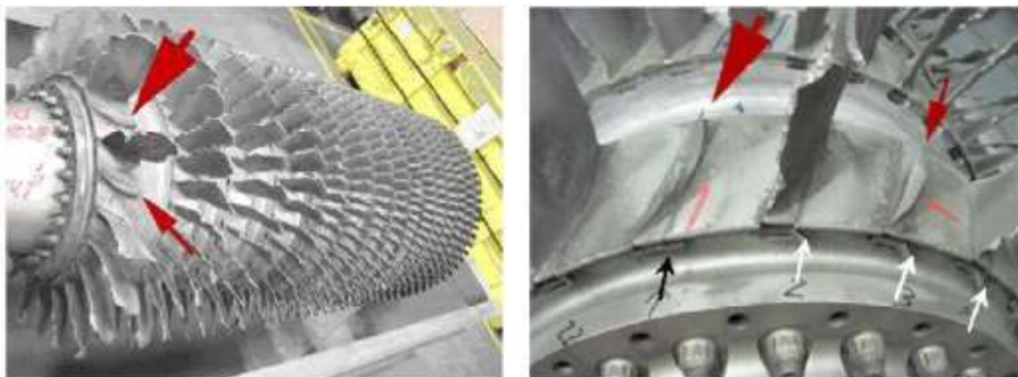
Figura 3.7. Fallas en la 1ra sección de álabes en las turbinas de gas.
