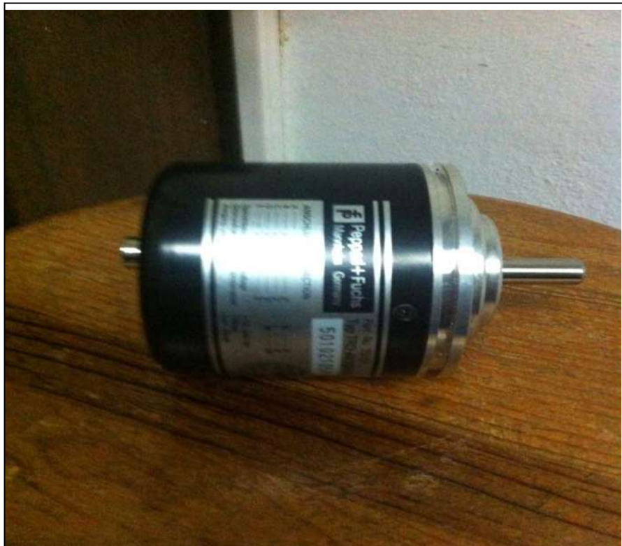
Figura 5.6.- Codificador óptico absoluto 10 bits.
