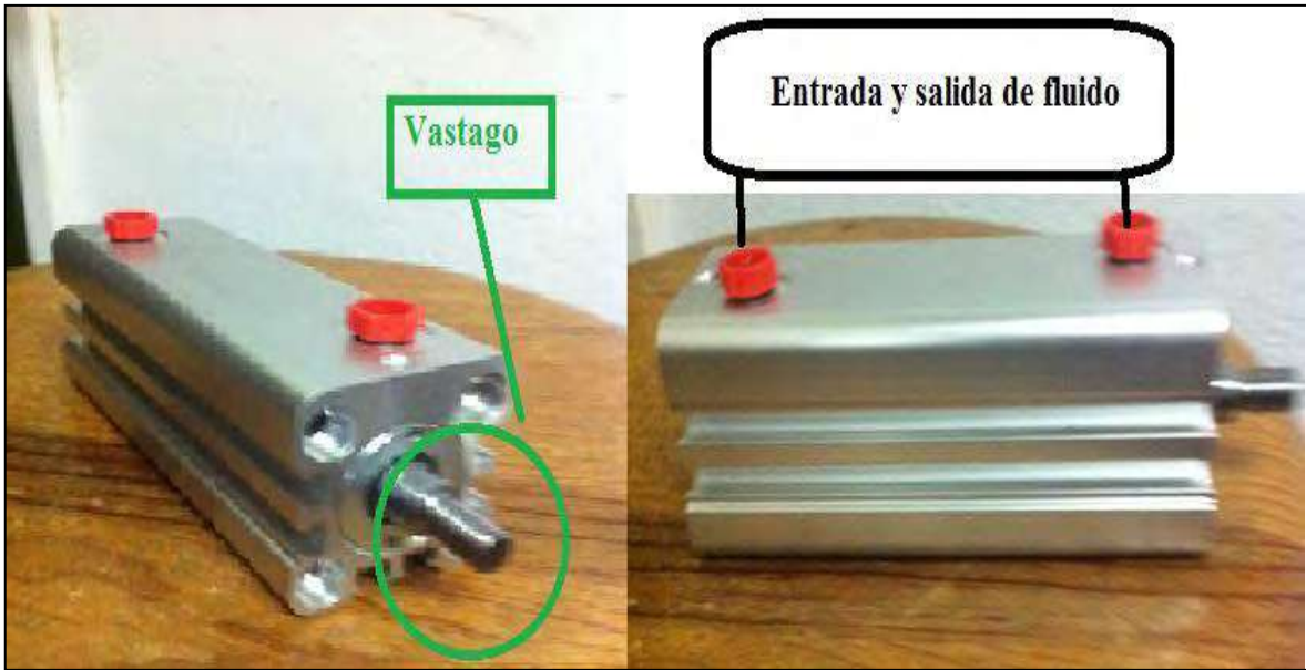
Figura 5.2.- Cilindro hidráulico de doble efecto.
