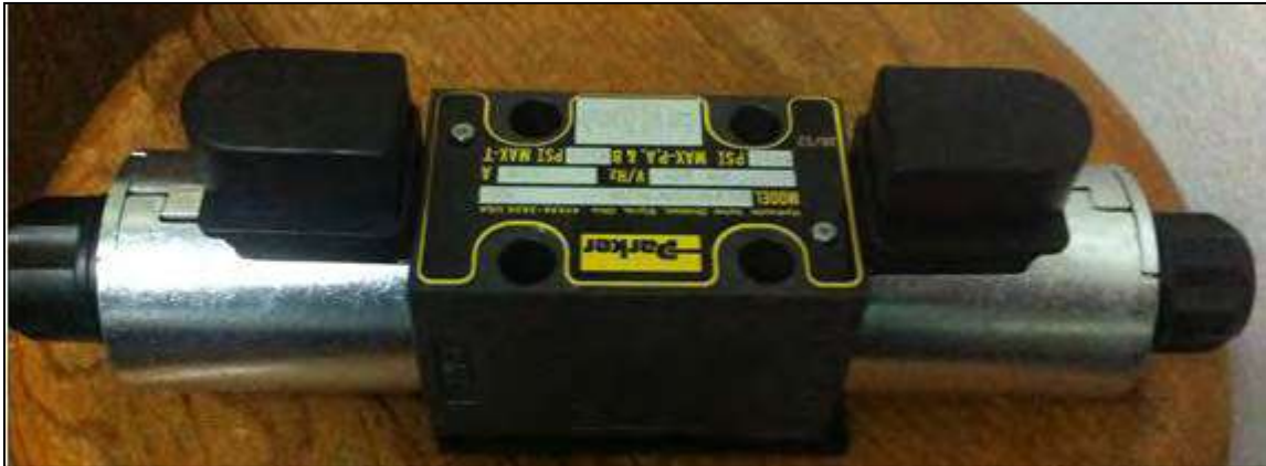
Figura 5.5.- Válvula direccional ON/OFF.
