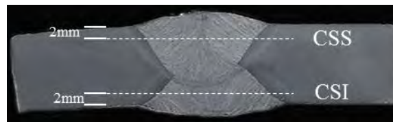
Figura 3.9 Localización donde se realizaron las mediciones de microdureza en las soldaduras de los aceros X-60 y X-70.
