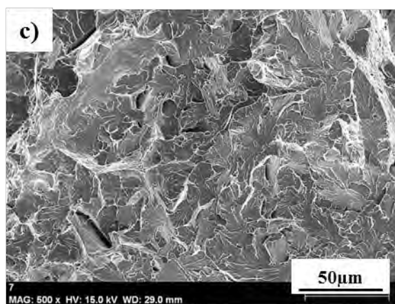
Figura 4.8 Imágenes obtenidas por MEB de las superficies de fractura de las pruebas de tenacidad al impacto en el acero API X-70 sin TT y con TT a 1050 °C y temple en agua; a) MB sin TT, b) MB con TT a 1050 °C/15 min y c) MB con TT a 1050 °C/30 min.
