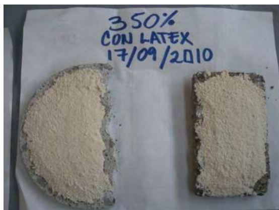
Figura 50. Sustratos y recubrimiento a un 350% solución KOH en baja concentración y con látex.
