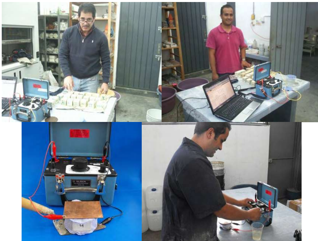
Figura 88. Procedimiento para obtener la resistividad de los cubos de 5x5x5.
