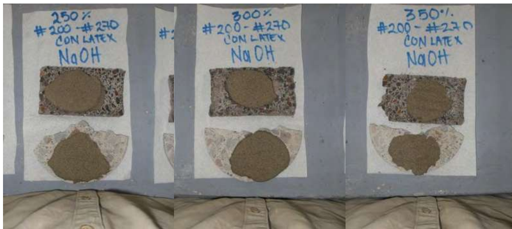
Figura 69. Sustratos y recubrimiento a un 250%, 300% y 350% solución NaOH en baja concentración y con látex.
