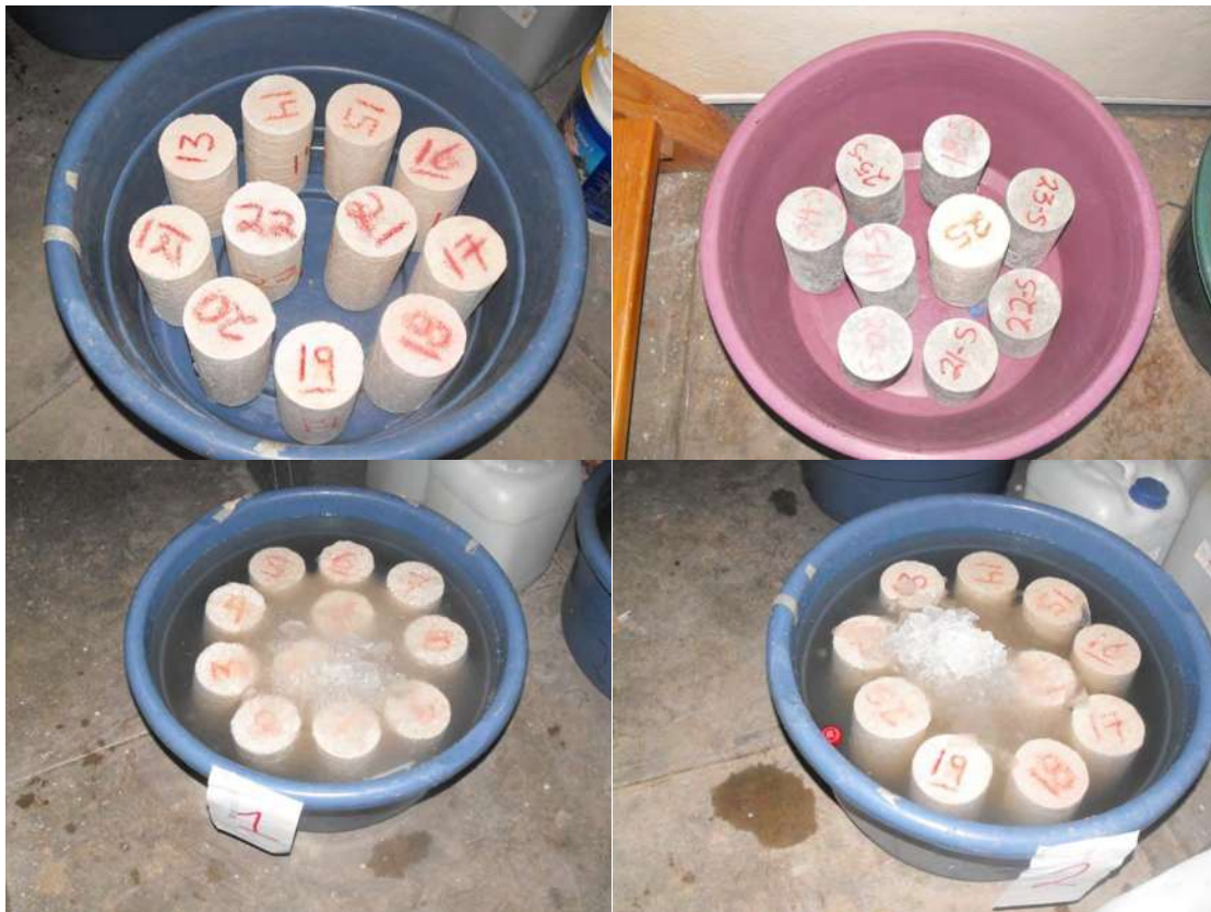
Figura 92. Inmersión de los cilindros a una solución saturada de \text{NaSO}_4 durante el primer ciclo.
