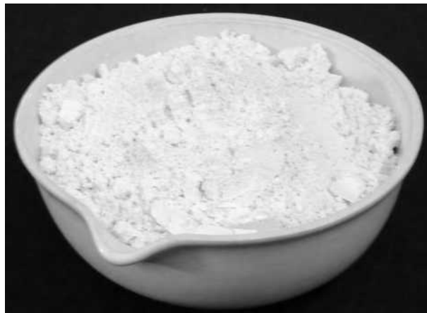
Figura 35. Metacaolín como material base en la elaboración de geopolímeros.
