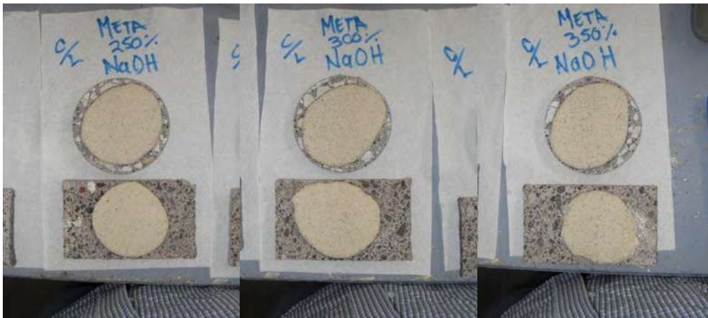
Figura 54. Sustratos y recubrimiento a un 250%, 300% y 350% solución NaOH en baja concentración y con látex.
