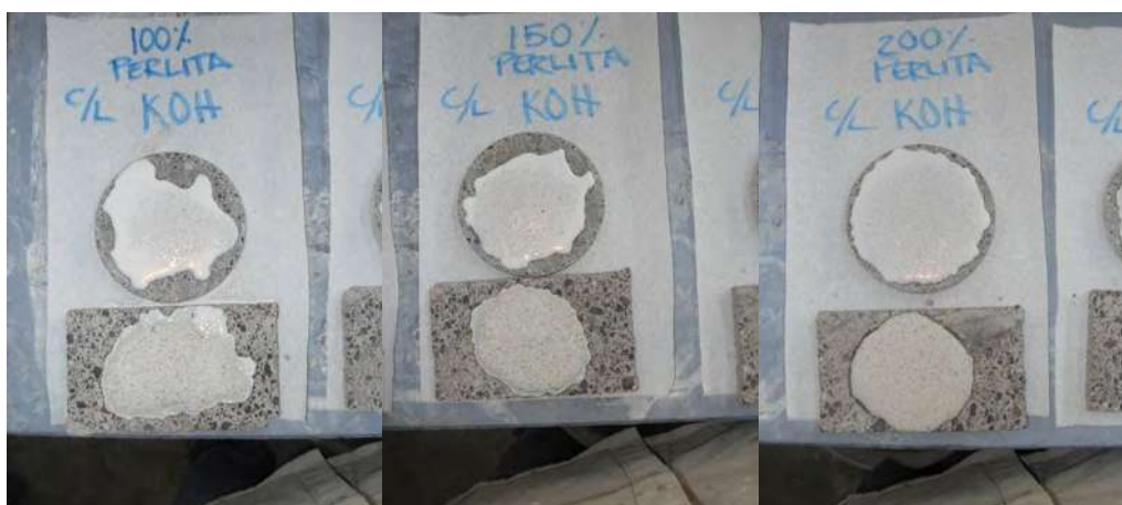
Figura 72. Sustratos y recubrimiento a un 100%, 150% y 200% solución KOH en baja concentración y con látex.
