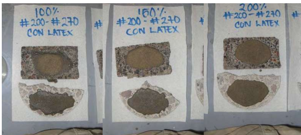
Figura 64. Sustratos y recubrimiento a un 100%, 150% y 200% solución KOH en baja concentración y con látex.
