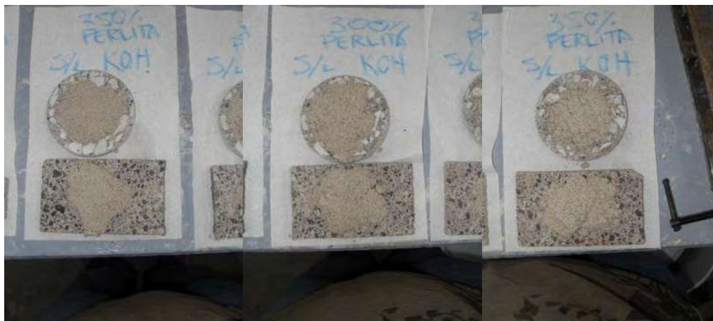
Figura 71. Sustratos y recubrimiento a un 250%, 300% y 200% solución KOH en baja concentración y sin látex.
