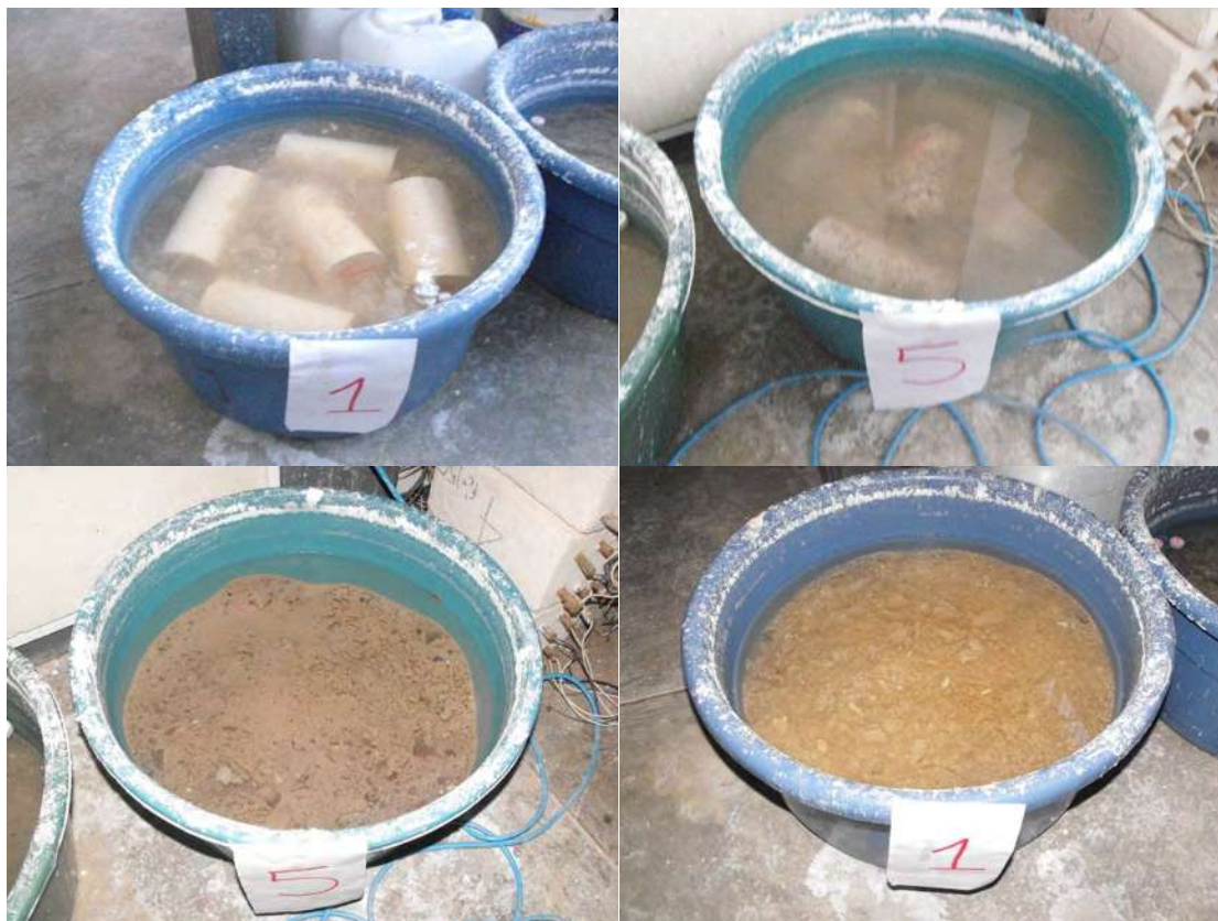
Figura 100. Inmersión de los cilindros a una solución saturada de \text{NaSO}_4 durante el quinto ciclo.
