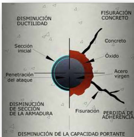
Figura 25. Consecuencias de la corrosión en el acero de refuerzo [Lee et al, 2006].
