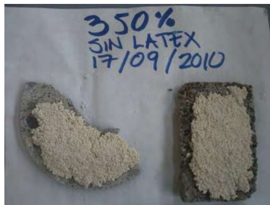
Figura 47. Sustratos y recubrimiento a un 350% solución KOH en baja concentración y sin látex.
