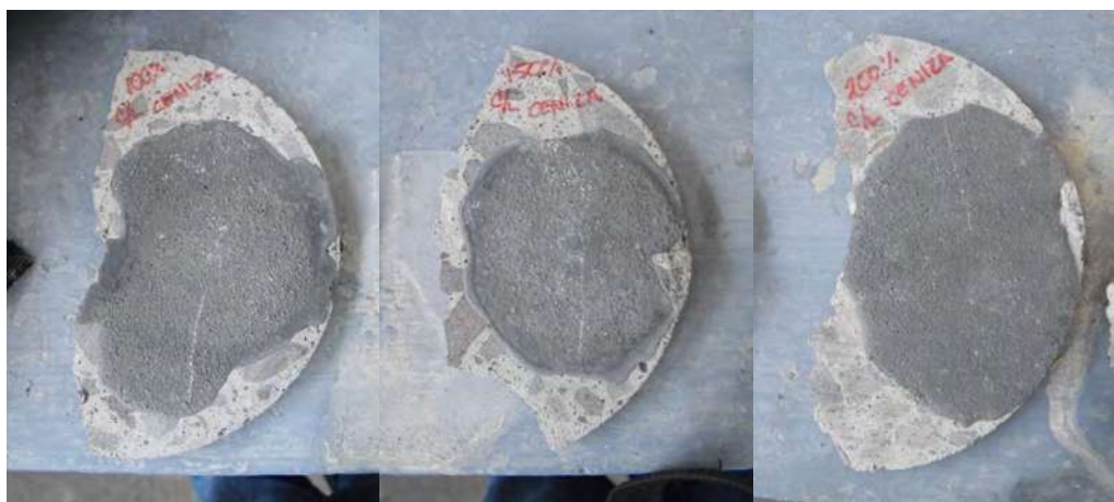
Figura 57. Sustratos y recubrimiento a un 100%, 150% y 200% solución KOH en baja concentración y con látex.
