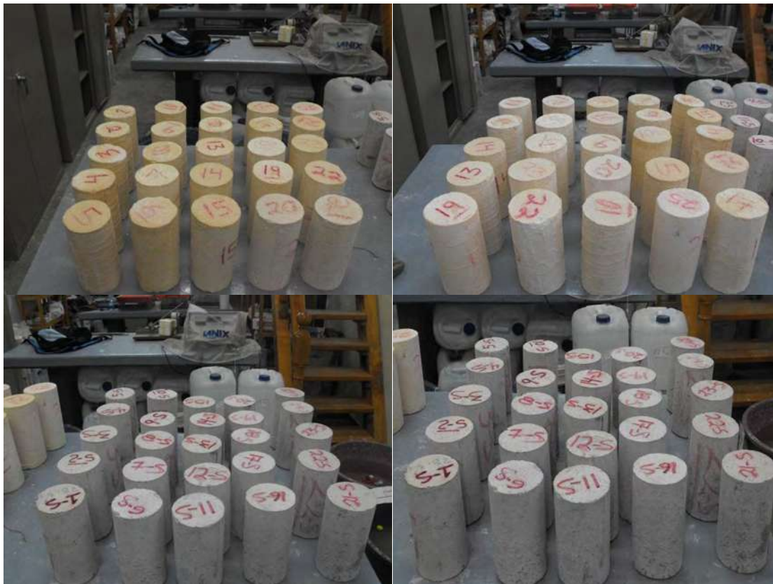
Figura 93. Cilindros después de estar en el horno por un periodo aproximado de 18 h en el primer ciclo.
