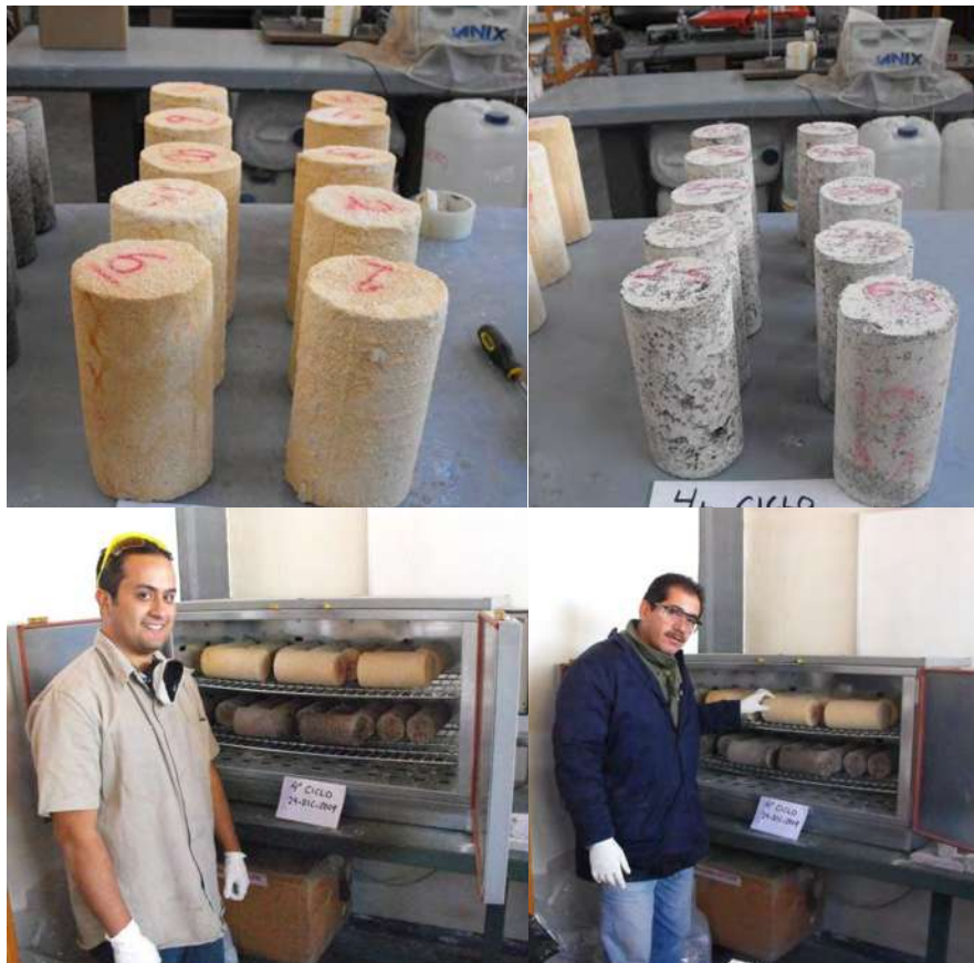
Figura 99. Cilindros después de estar en el horno por un periodo aproximado de 24 h en el cuarto ciclo.
