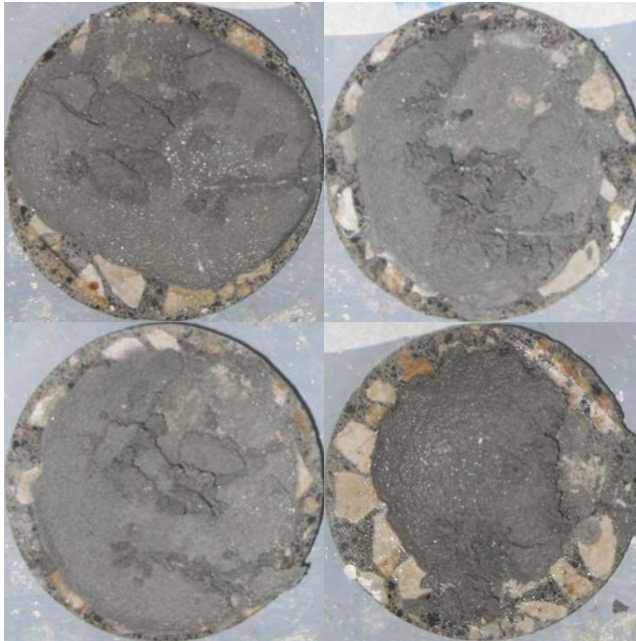
Figura 77. Resultados de la prueba en sustratos de ceniza de escoria con una solución de NaOH.
