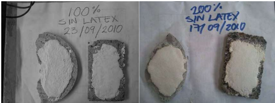
Figura 45. Sustratos y recubrimiento a un 100% y 200% solución KOH en baja concentración y sin látex.
