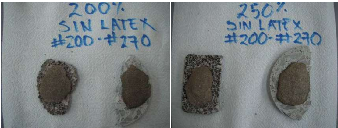
Figura 62. Sustratos y recubrimiento a un 200%, y 250% solución KOH en baja concentración y sin látex.
