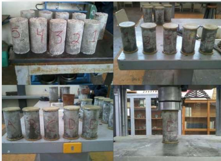
Figura 89. Cilindros elaborados para comprobar que la resistencia proyectada fue físicamente parecida.
