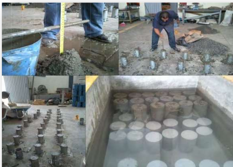
Figura 90. Elaboración y curado de cilindros.
