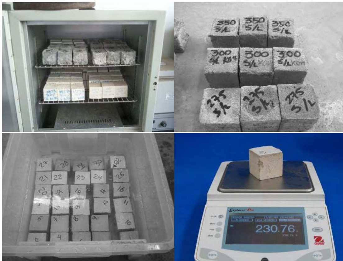
Figura 87. Procedimiento para obtener la absorción en cubos de 5x5x5 cm.
