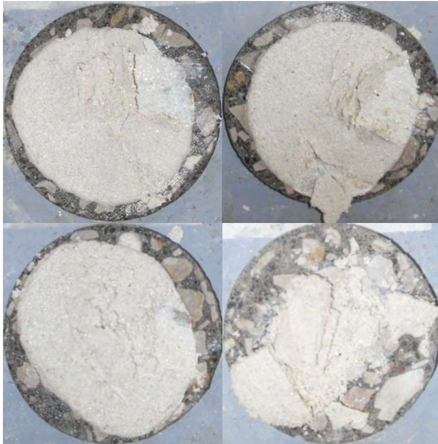
Figura 76. Resultados de la prueba en sustratos de metacaolín con una solución de NaOH.
