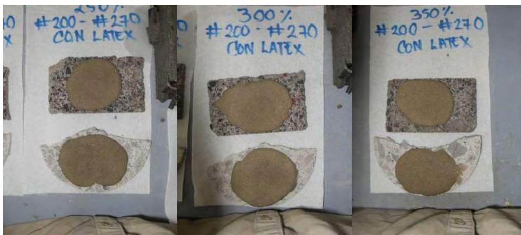
Figura 65. Sustratos y recubrimiento a un 250%, 300% y 350% solución KOH en baja concentración y con látex.
