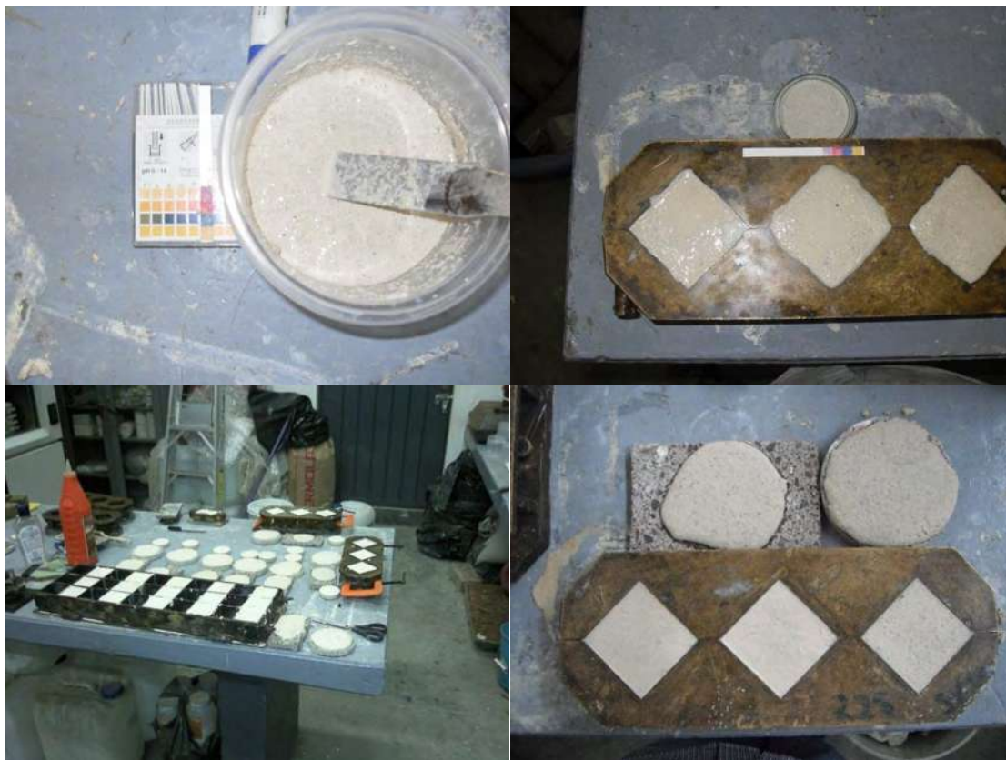
Figura 85. Elaboración de cubos a base de metacaolín y una solución con una alta concentración.
