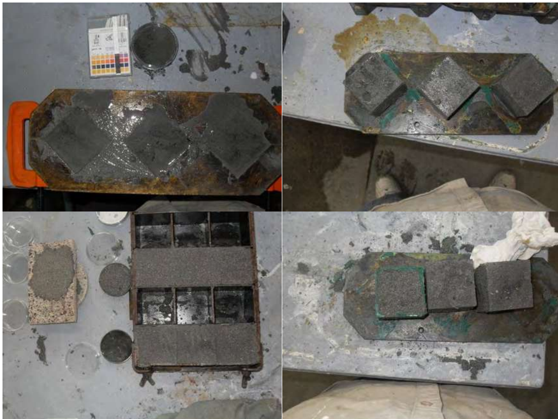
Figura 86. Elaboración de cubos a base de ceniza de escoria y una solución con una alta concentración.
