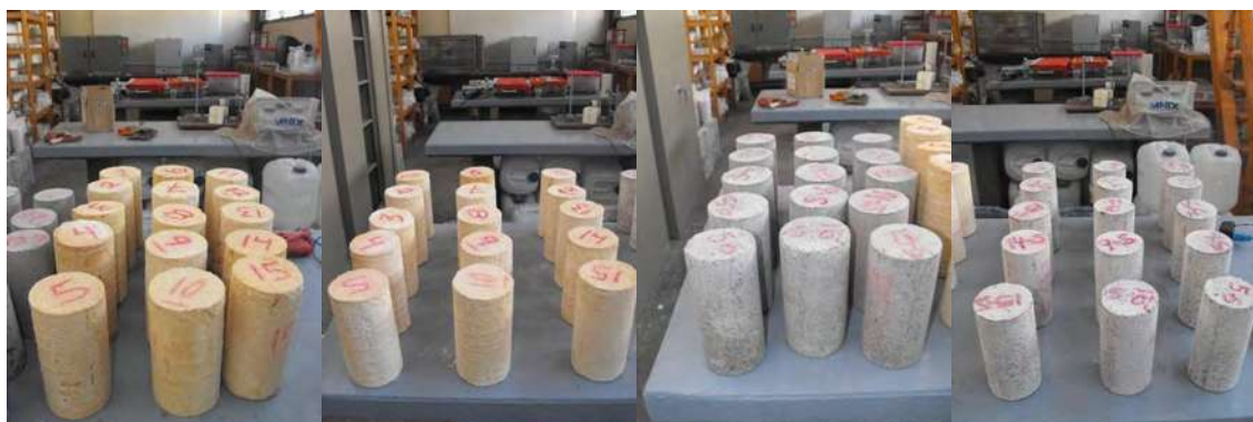
Figura 97. Cilindros después de estar en el horno por un periodo aproximado de 18 h en el tercer ciclo.
