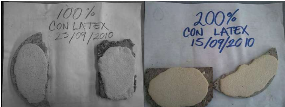
Figura 48. Sustratos y recubrimiento a un 100% y 200% solución KOH en baja concentración y con látex.
