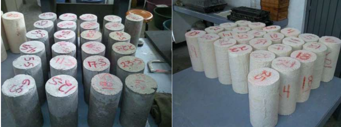
Figura 91. Cilindros sin recubrimiento (testigos) y cilindros recubiertos.
