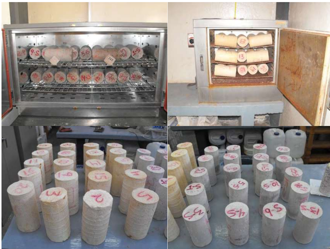
Figura 95. Cilindros después de estar en el horno por un periodo aproximado de 18 h en el segundo ciclo.
