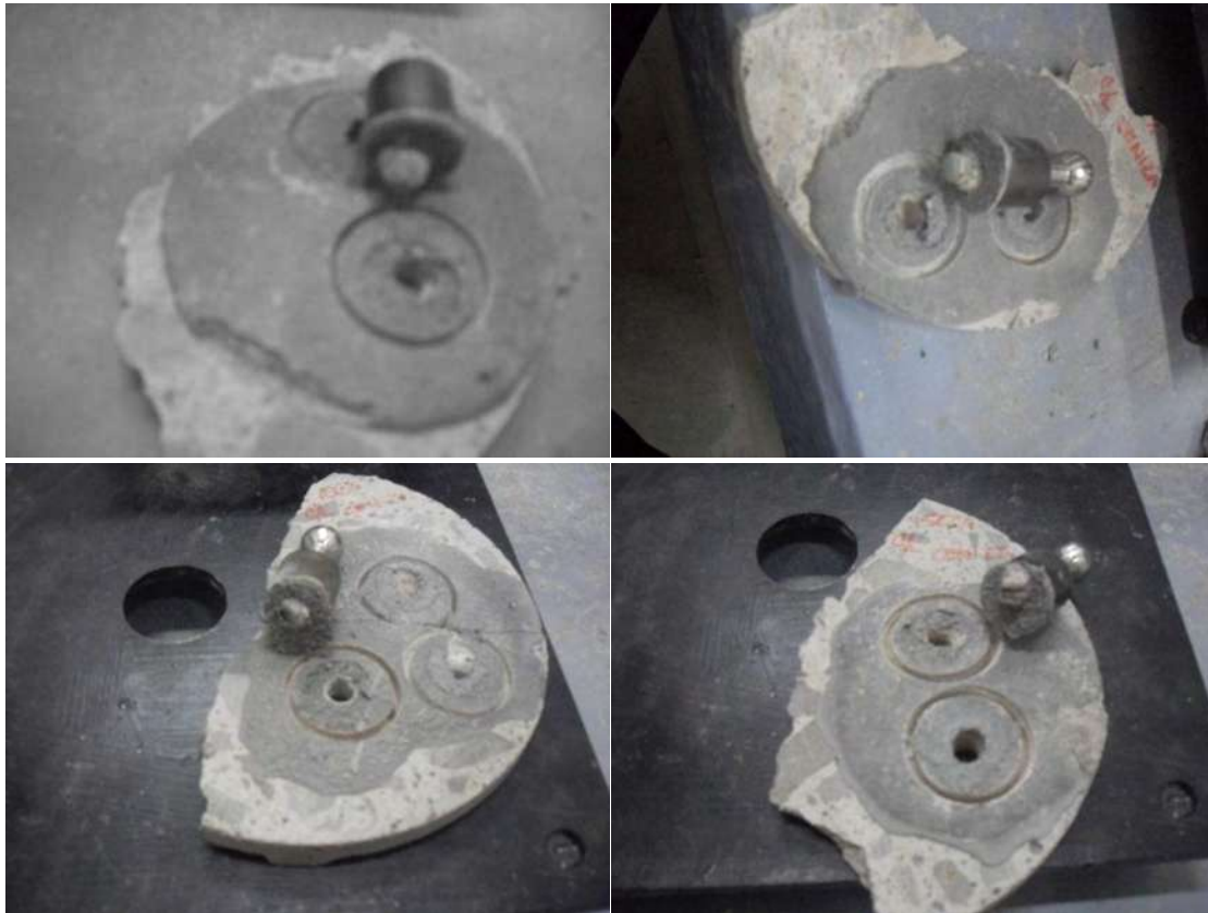
Figura 81. Muestras elaboradas a base de ceniza de la termoeléctrica, con látex e hidróxido de potasio en alta concentración.
