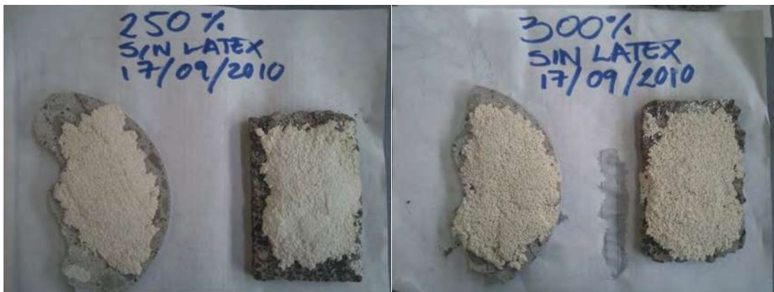
Figura 46. Sustratos y recubrimiento a un 250% y 300% solución KOH en baja concentración y sin látex.
