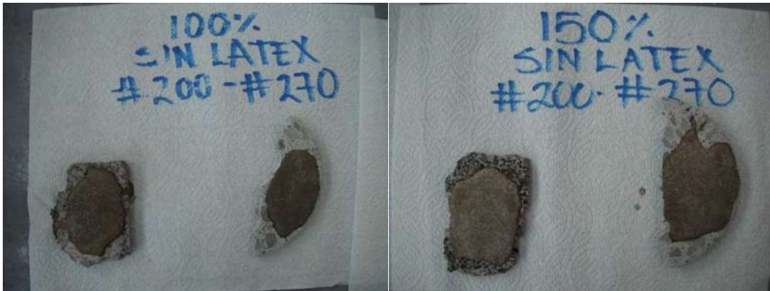
Figura 61. Sustratos y recubrimiento a un 100%, y 150% solución KOH en baja concentración y sin látex.
