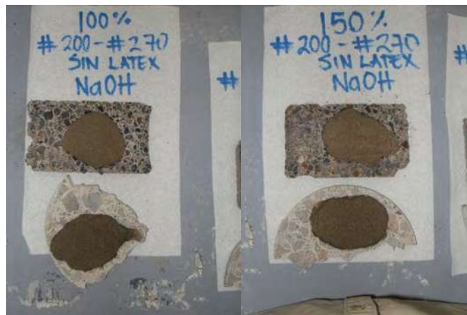
Figura 66. Sustratos y recubrimiento a un 100% y 150% solución NaOH en baja concentración y sin látex.
