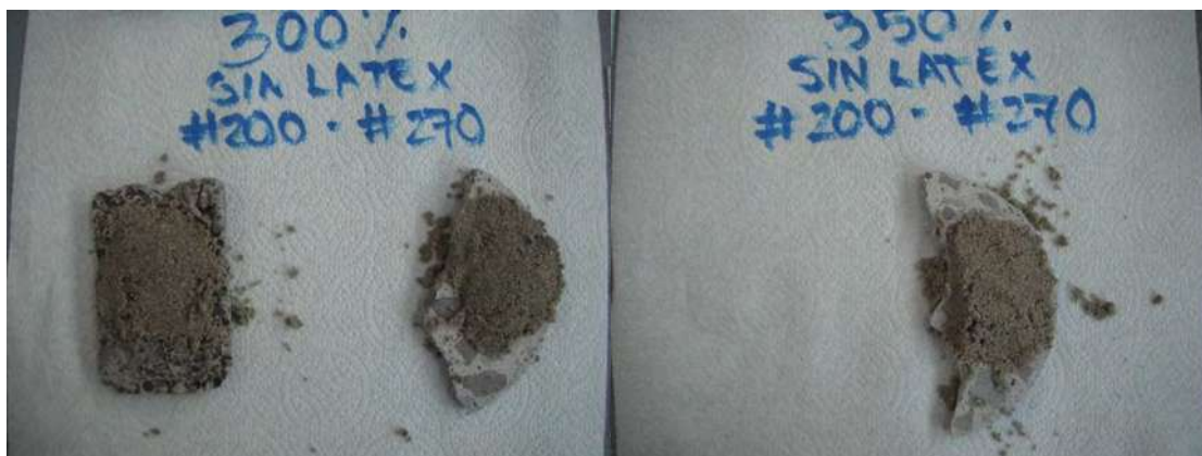
Figura 63. Sustratos y recubrimiento a un 300%, y 350% solución KOH en baja concentración y sin látex.
