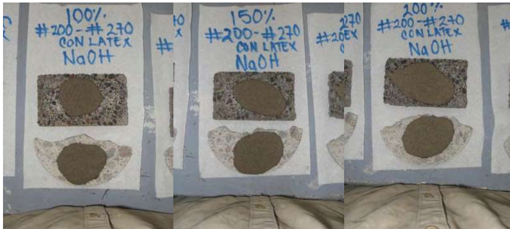
Figura 68. Sustratos y recubrimiento a un 100%, 150% y 200% solución NaOH en baja concentración y con látex.
