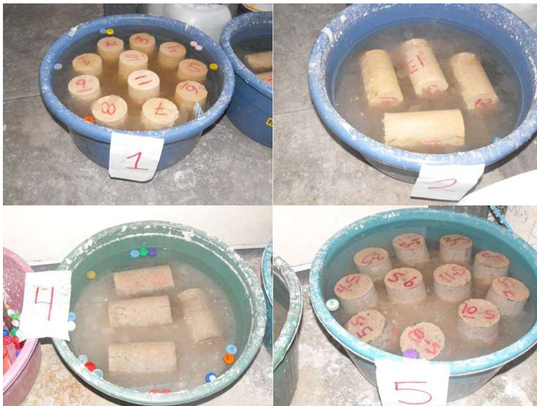
Figura 96. Inmersión de los cilindros a una solución saturada de \text{NaSO}_4 durante el tercer ciclo.
