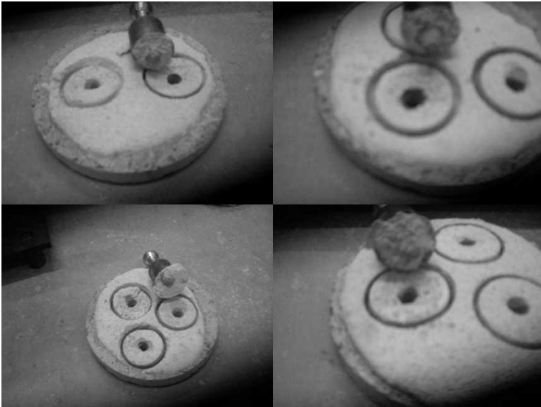
Figura 79. Muestras elaboradas a base de metacaolín sin látex e hidróxido de sodio en alta concentración.
