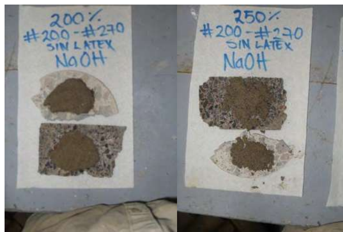
Figura 67. Sustratos y recubrimiento a un 200% y 250% solución NaOH en baja concentración y sin látex.
