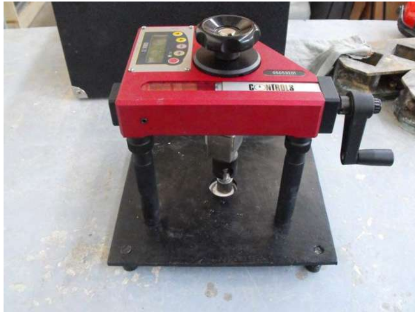
Figura 39. Equipo para prueba Pull Off marca CONTROLS.
