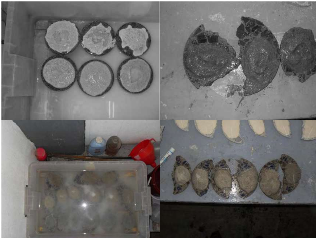
Figura 75. Resultados de la prueba en sustratos de perlita y polvo de grava triturada con una solución de NaOH.
