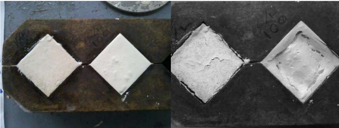
Figura 82. Colado de cubos con una solución a base de metacaolín y una solución de baja concentración.
