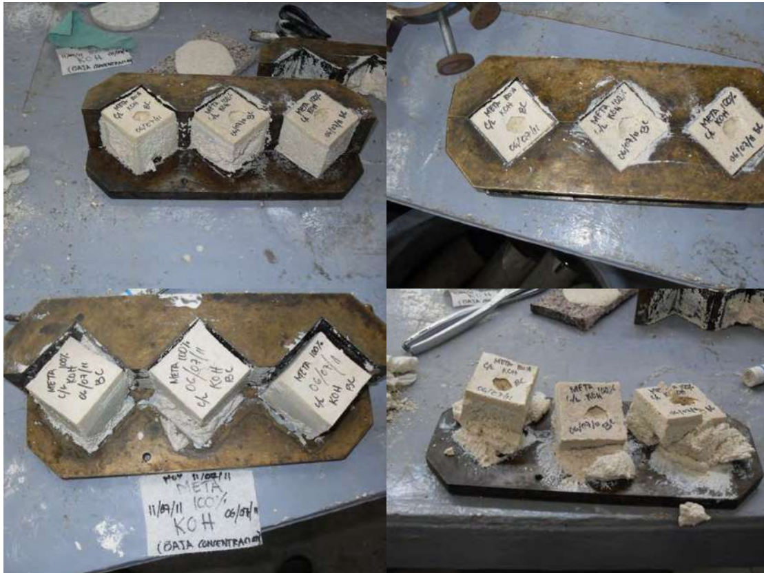
Figura 84. Cubos descimbrados a los 5 días de haber sido colados.
