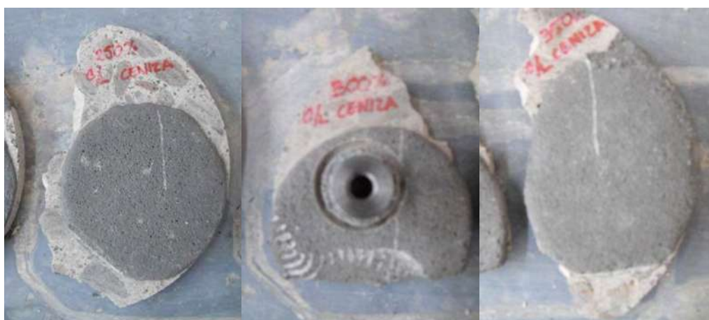
Figura 58. Sustratos y recubrimiento a un 250%, 300% y 350% solución KOH en baja concentración y con látex.
