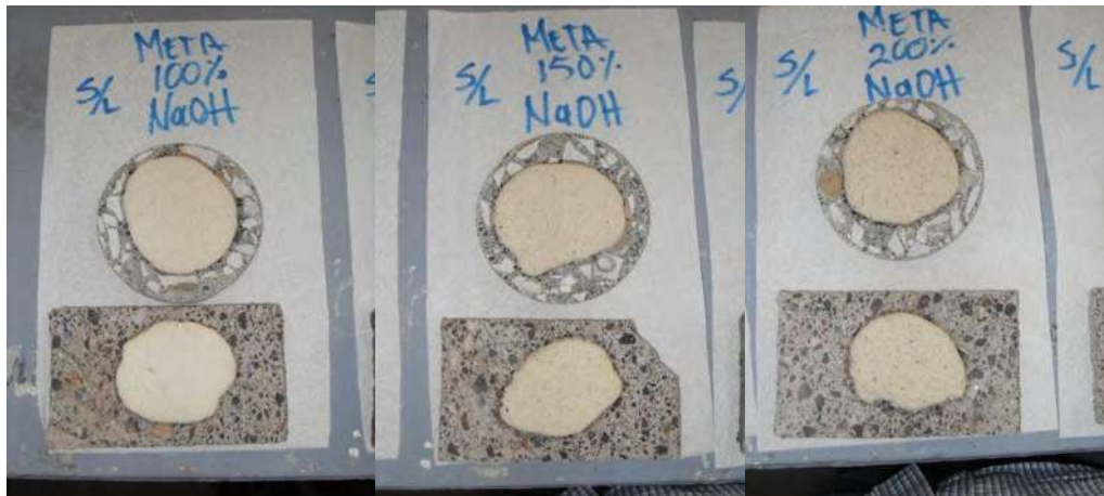
Figura 51. Sustratos y recubrimiento a un 100%, 150% y 200% solución NaOH en baja concentración y sin látex.
