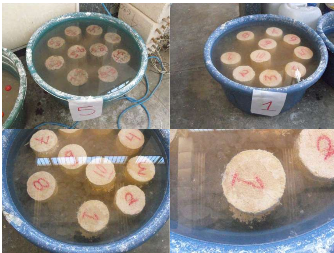
Figura 98. Inmersión de los cilindros a una solución saturada de \text{NaSO}_4 durante el cuarto ciclo.
