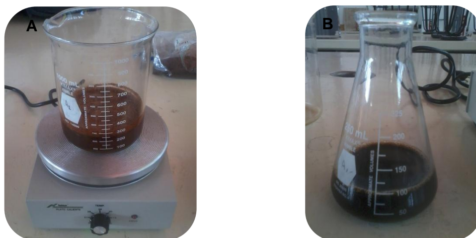
Figura 15. A) Extracción acuosa y B) Aforación del resultante.
