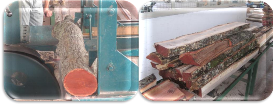
Figura 5. Cortes para pruebas físicas y mecánicas.
