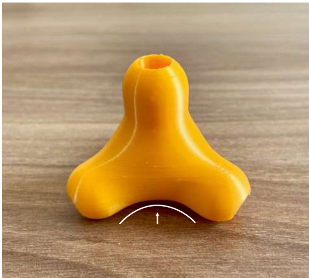
F66. Impresión 3d de la Quinta Exploración en filamento PLA naranja con una boquilla de 0.4mm de diámetro. N. Martínez, (2020), Julio 28, 2020.
