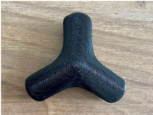
F58. Primer Pieza Impresa en 3d con filamento PETG en color negro con una boquilla de 0.4mm de diámetro, N. Martínez, (2020), Julio 28, 2020.
