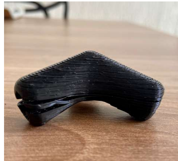
F59. Primer Pieza Impresa en 3d colapsada, N. Martínez, (2020), Julio 28, 2020.
