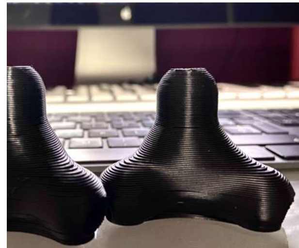
F79. Impresión 3d de la Sexta Exploración con filamento PLA Negro con boquilla de 0.6mm de diámetro con relleno de Gyroide y Rejilla, N. Martínez, (2002), Noviembre 8, 2020.
