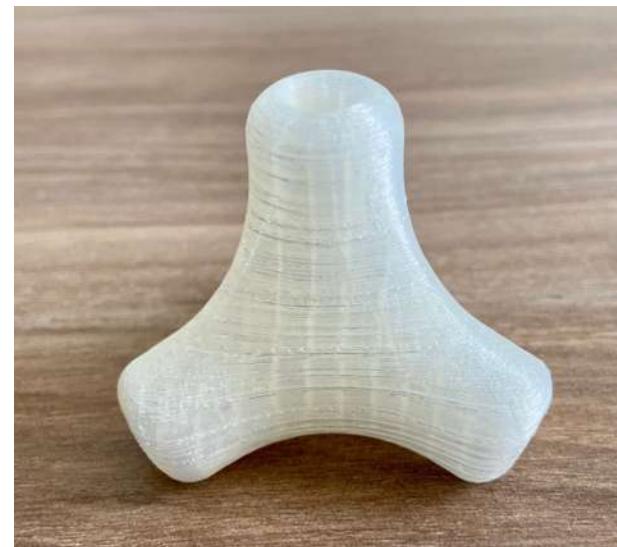
F63. Prototipo impreso en 3d con filamento PLA con filled en los ángulos con un radio de 15mm. N. Martínez, (2020), Julio 28, 2020.
