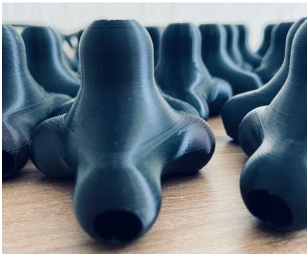
F77. Impresión 3d de la Quinta Exploración con filamento PLA Negro con boquilla de 0.4mm de diámetro con relleno de rejilla, N. Martínez, (2002), Octubre 30, 2020.
