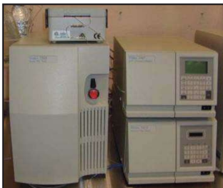
Figura 3.9. Equipo empleado para análisis de pesos moleculares en polímeros.
