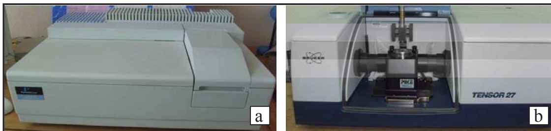
Figura 3.10. Equipos empleados para análisis espectroscópico a) UV-vis; y b) FTIR.
