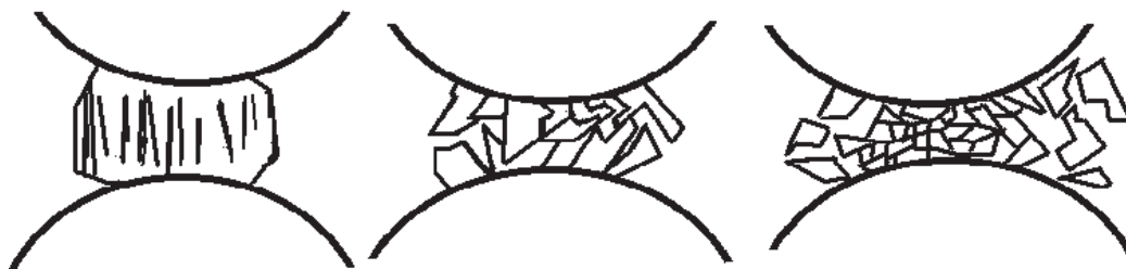
Figura 1.14.- Esquema de MM componente frágil – frágil.
