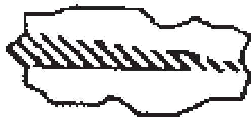
Figura 1.7.- Esquema de una partícula en las primeras etapas de molienda.
