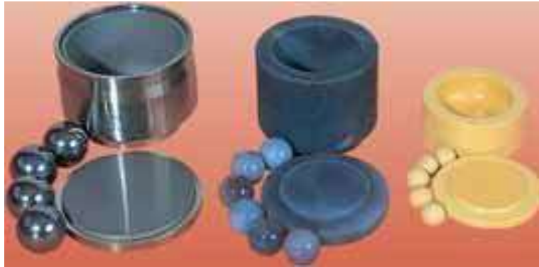
Figura 1.19.- Imagen de los diferentes tipos y composiciones de contenedores y bolas de molienda.
