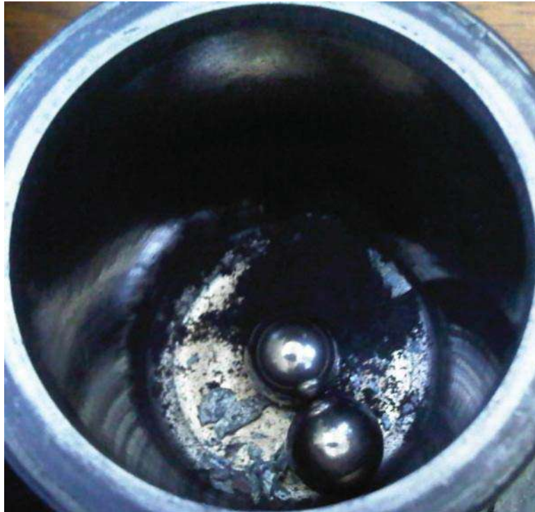
Figura 2.6.- Imagen del vial antes de la Molienda Mecánica con etanol.
