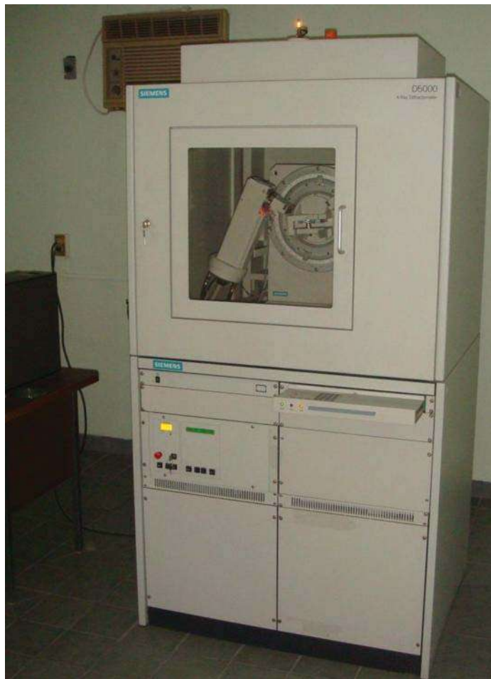
Figura 2.7.- Difractómetro Siemens D5000 utilizado para la caracterización estructural de todas las muestras (intermetálico y polvos).
