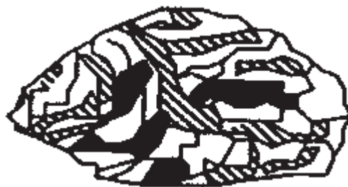
Figura 1.9.- Esquema de una partícula que presenta varias capas fracturadas y re-unidas.
