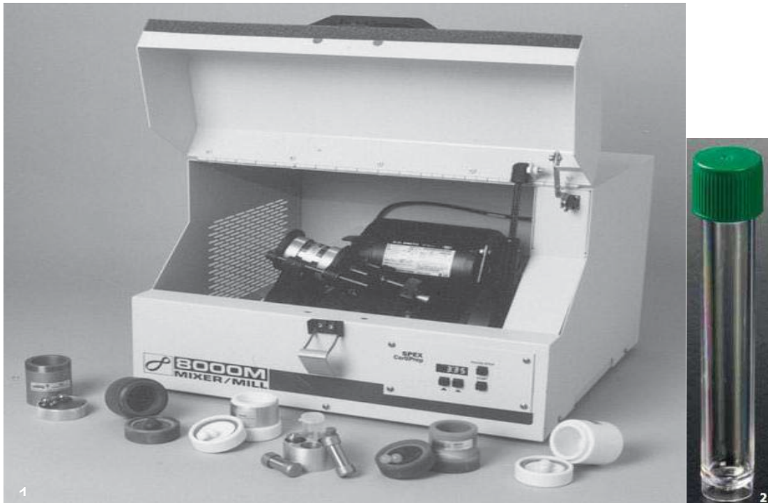
Figura 2.3.- (1) Imagen del molino tipo SPEX 8000M utilizado para la molienda mecánica, mostrando en la parte inferior los diferentes tipos de contenedores para la molienda; (2) Contenedor de polipropileno para almacenamiento de polvos.
