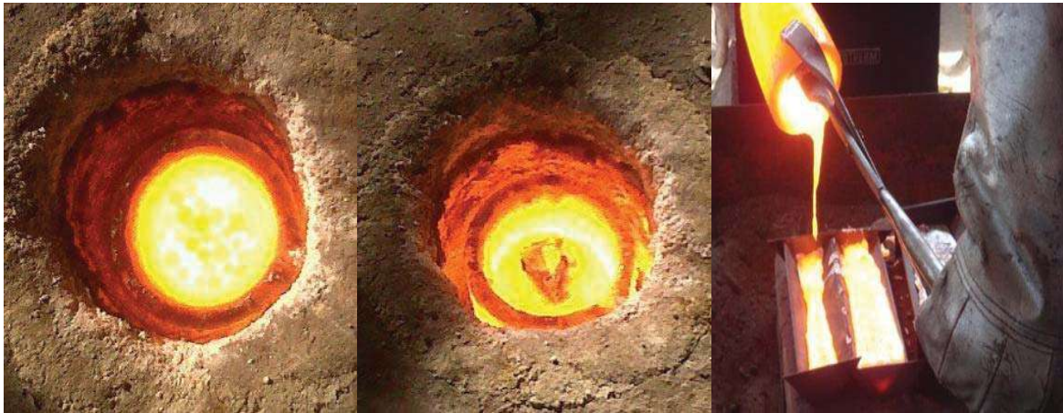
Figura 2.2.- Imágenes del proceso de fundición: a) Fusión del Ni; b) Al agregándose al Ni; c) Vaciado en el molde.
