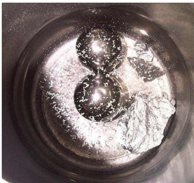
Figura 2.4.- Imagen del interior del vial antes de la Molienda Mecánica con agua.
