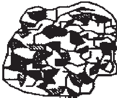
Figura 1.10.- Esquema de una partícula que contiene los materiales iniciales, obtenida después del proceso de molienda mecánica.
