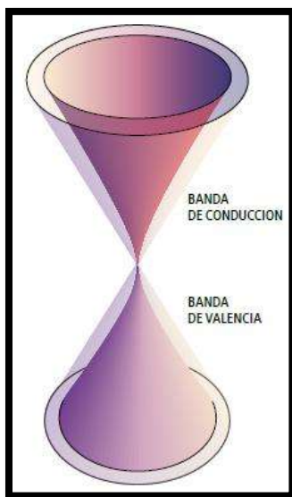
Figura 2. Bandas electrónicas del grafeno en forma de dos conos invertidos. Estos se unen por el punto de unión y aparentemente la brecha energética es tan pequeña, que puede considerarse como despreciable. En este sentido, los electrones pueden pasar fácilmente del cono inferior al superior.
