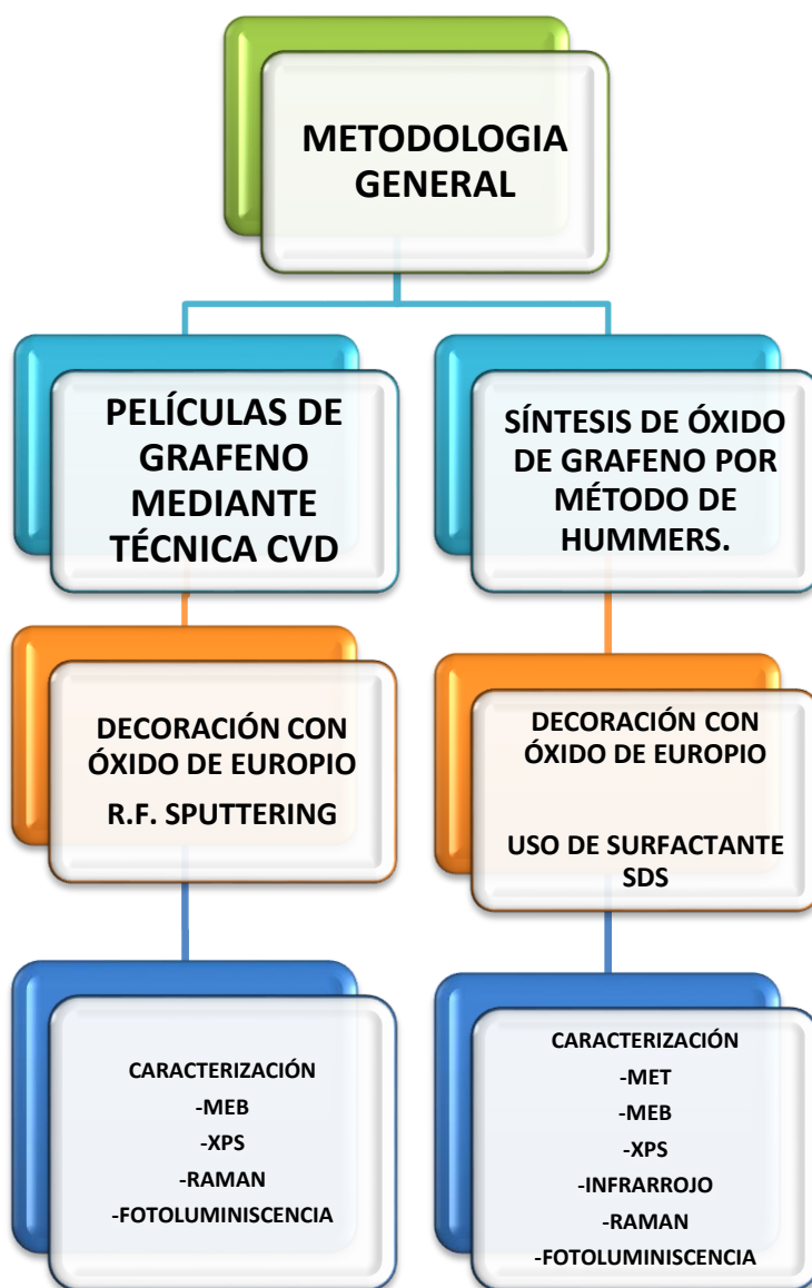
Figura 10. Metodología General para la producción de óxido de grafeno y películas de grafeno.
