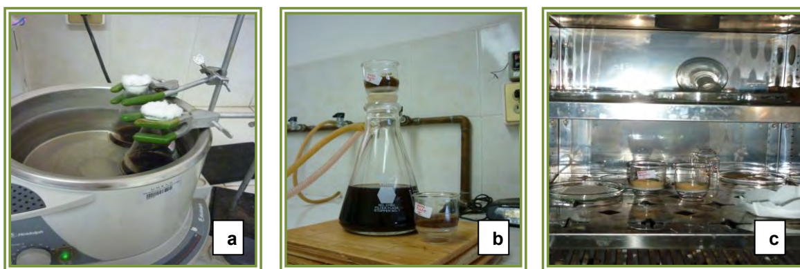
Fig. 11. Proceso de la solubilidad a la sosa, a) baño maría, b) filtrado c) secado.
