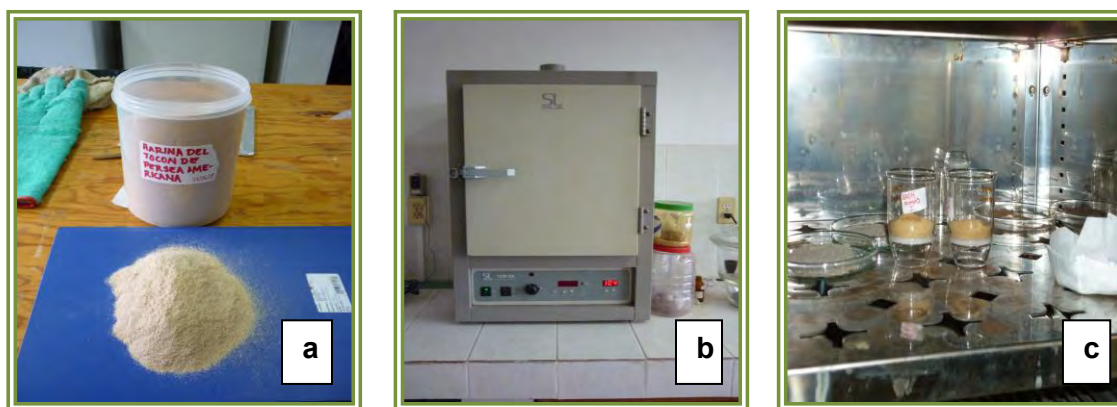
Fig. 7. Secuencia para obtener el Contenido de Humedad de la especie. a) harina de madera, b) estufa de secado, c) muestras a peso constante.
