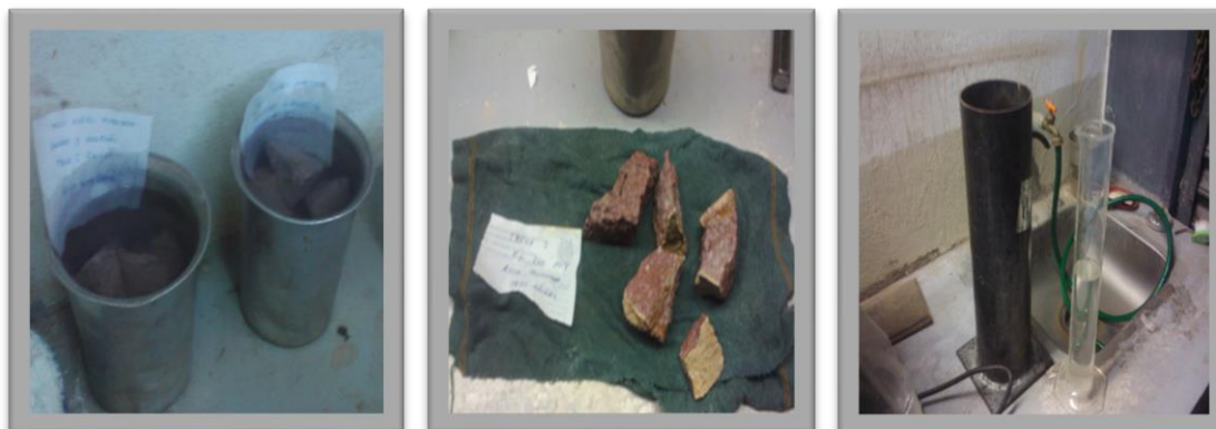
Figura 4.31.- Secuencia de la prueba de densidad y absorción.
