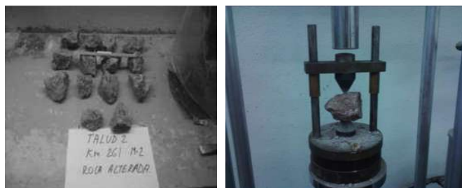
Anexo B- Imagen 10. Pceso de prueba carga puntual de la tabla A.B.2
