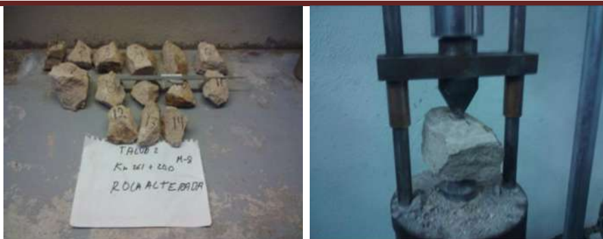
Anexo B. Imagen 12. Pceso de prueba carga puntual de la tabla A.B.7
