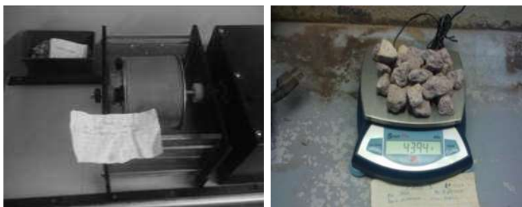
Anexo A-Imagen 8.- Pocesio de prueba de Durabilidad talud 2 lado Sur (Riolita)
