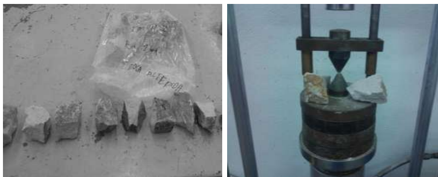
Anexo B- Imagen 9.- Pceso de prueba carga puntual de la tabla A.B.1.
