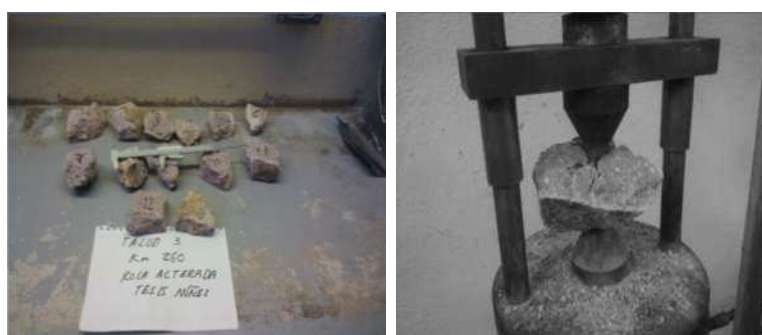
Anexo B-Imagen 16.- Pceso de prueba carga puntual de la tabla A.B.11.
