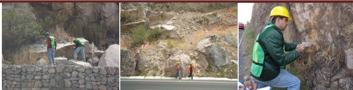
Figura 4.21.- Lecturas con el esclerómetro del talud 1 en el km 261+000 lado Este fragmentos de roca.
