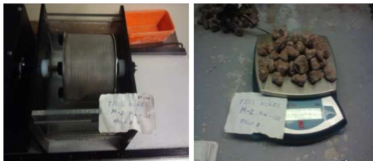
Anexo A- Imagen1.- Proceso de prueba de Durabilidad talud 1 lado Oeste (Riolita)
