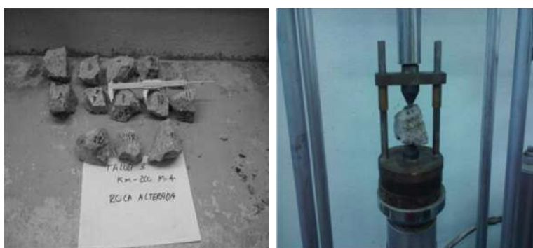
Anexo B- Imagen 14.- Pceso de prueba carga puntual de la tabla A.B.9.
