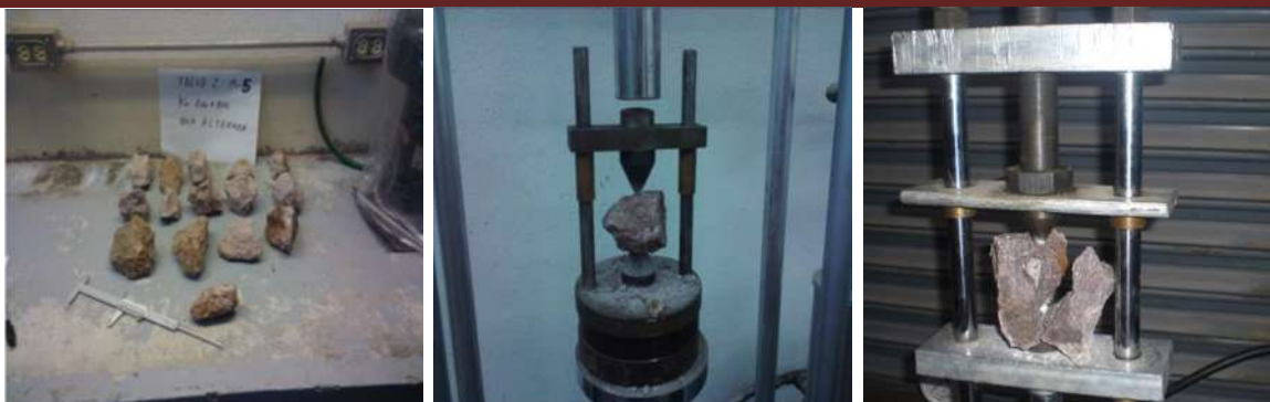
Figura 4.34.- Secuencia de la prueba de Carga Puntual con muestras de los taludes 1 y 2, roca Riofítica.
