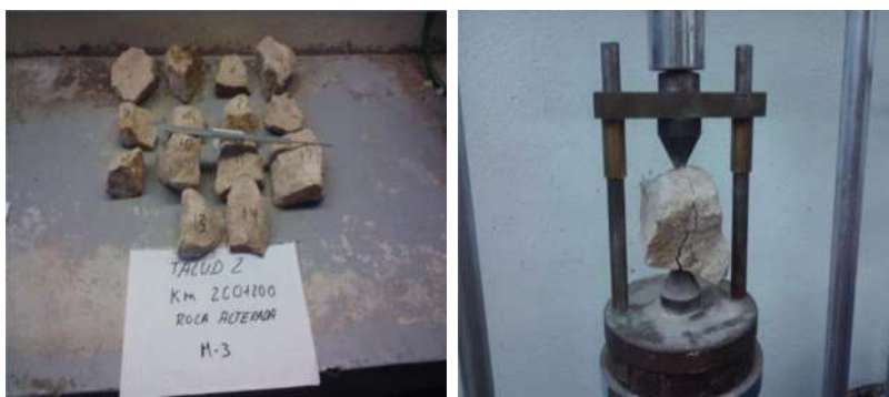
Anexo B- Imagen 13.- Pceso de prueba carga puntual de la tabla A.B.8
