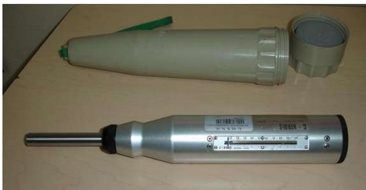
Figura 3 10.- Esclerómetro empleado para conocer la resistencia en campo de la roca.
