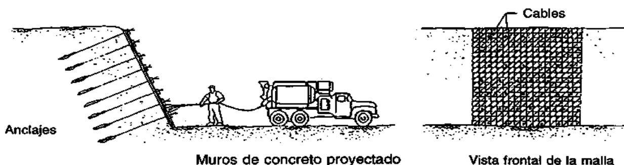
Figura 3.29.- Proceso de estabilización con un sistema de mallas y anclaje como alternativa económica y viable para taludes rocosos.
