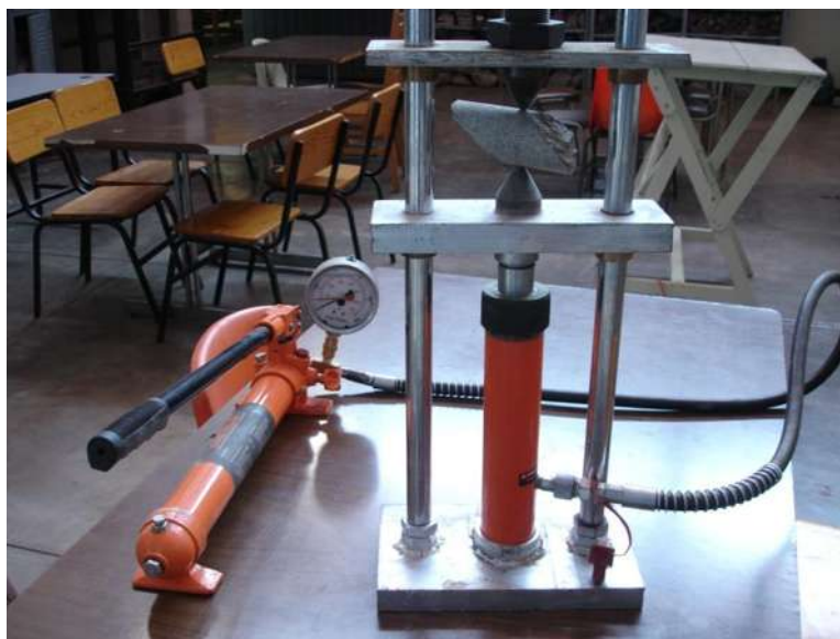
Figura 3.13.- Equipo empleado para la carga puntual en laboratorio.
