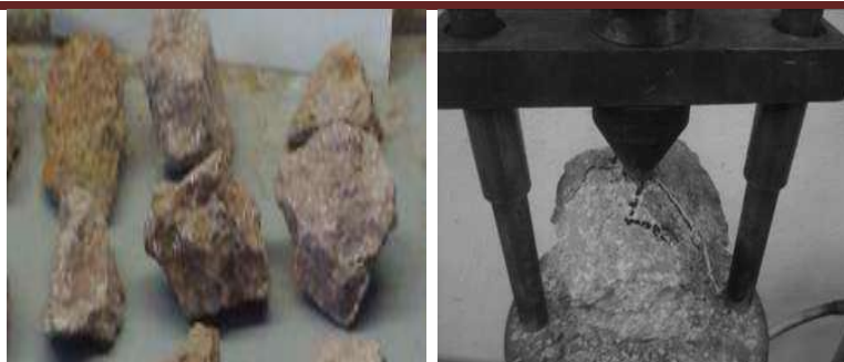
Anexo B-Imagen 15.- Pceso de prueba carga puntual de la tabla A.B.10.
