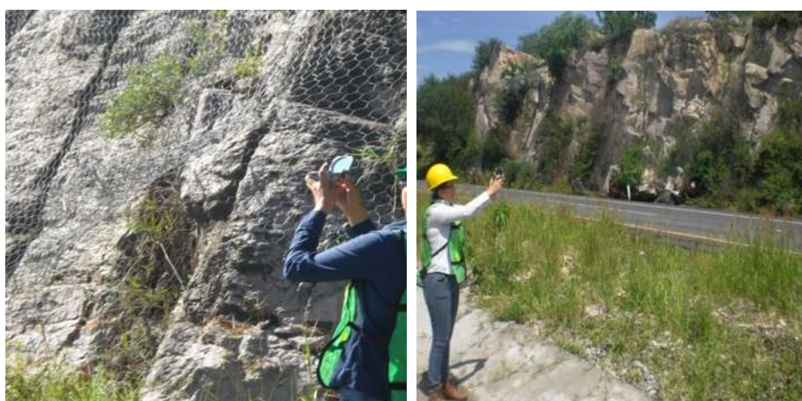
Figura 4.29.- Lecturas de las discontinuidades desde la parte central de la autopista.
