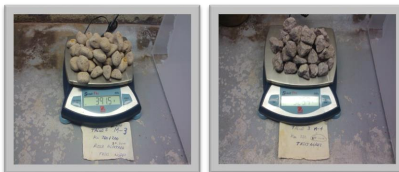
Figura 4.33.- Pesado del Material previo a un ciclo de prueba.
