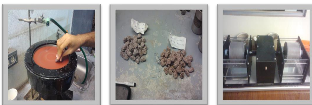
Figura 4.32.- Secuencia de la prueba de Durabilidad hecha a las muestras representativas de los taludes 1 y 2 de roca Toba.
