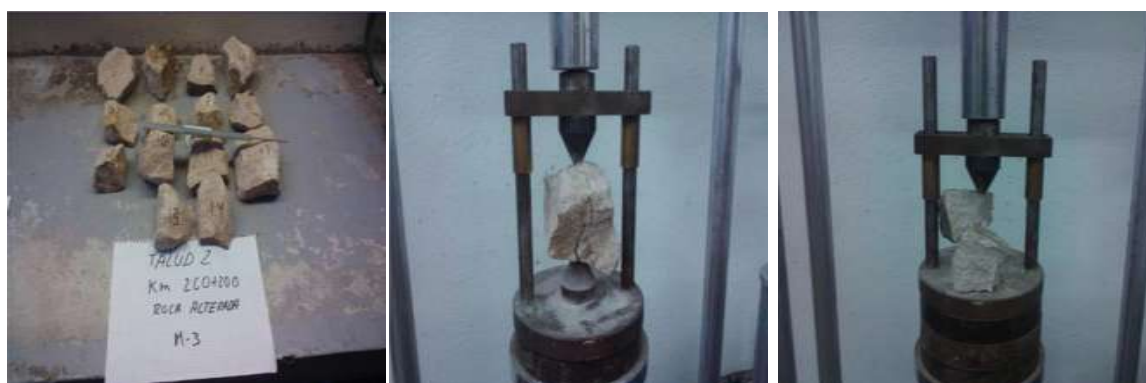
Figura 4.35.- Secuencia de la prueba de Carga Puntual con muestras de los taludes 1 y 2, Toba.
