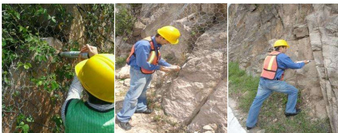
Figura 4.22.- Lecturas con el esclerómetro en el km 261+000 lado Oeste (Toba y Riolfita).
