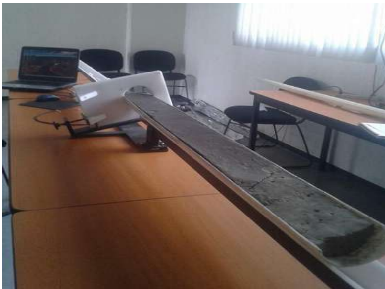
Figura 15. Medida de la (X) de los núcleos de sedimento con un sensor en forma de anillo modelo (MS2C) de 100 mm de diámetro a cada 2 cm de distancia.
