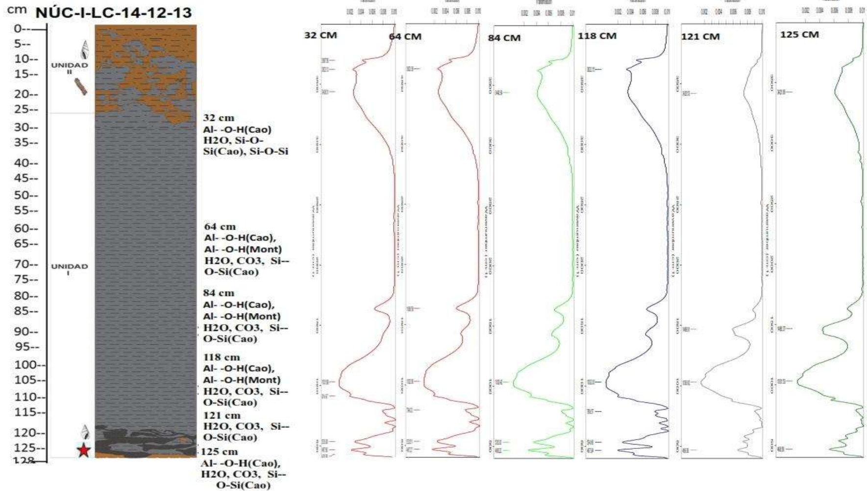
Figura 47, presenta la columna estratigráfica y las unidades cristaloquímicas de los minerales presentes en los seis espectrogramas a diferente profundidad de muestreo.
