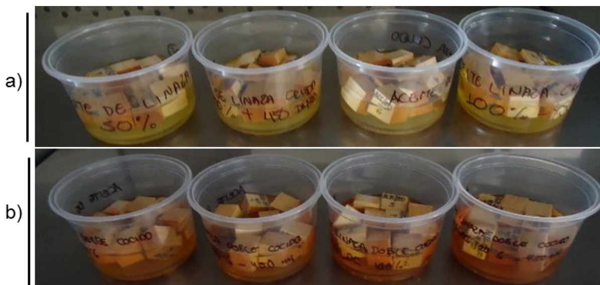
Figura 8. Probetas de Pinus sp. impregnadas durante 48 horas. a) DMHDA-aceite de linaza crudo; b) DMHDA-aceite de linaza doble cocido.
