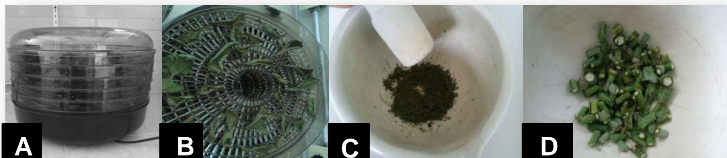
Figura 27. Preparación de material vegetal para extracción de compuestos: A) Deshidratador, B) Hojas distribuidas de manera uniforme en los platos del deshidratador, C) Pulverización, D) Reducción de tamaño de los tallos
