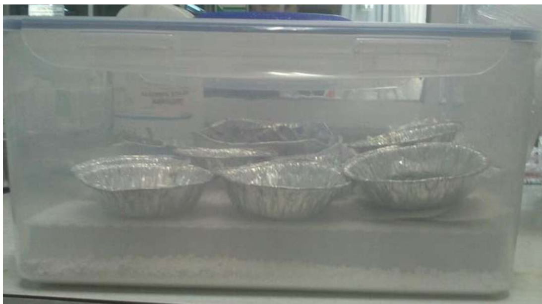
Figura 2. Cápsulas de pesaje con muestras de forraje dentro del desecador después del proceso de deshidratación.
