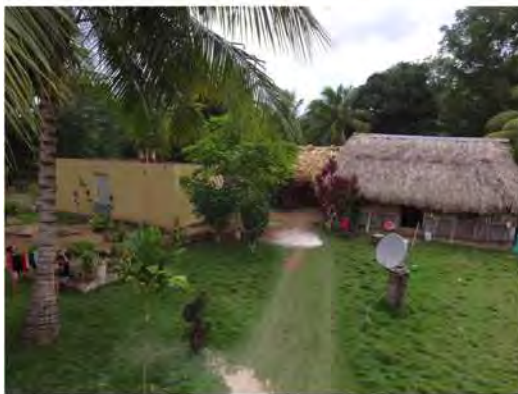
Núcleo con muros de tasiste y techo de huano. Chacchoben, Quintana Roo.
