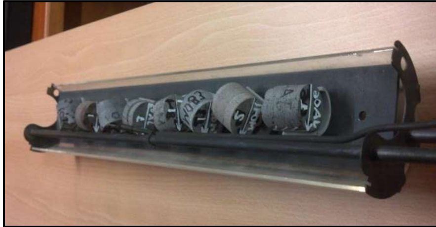
Figura 4. 8 Para el método de múltiples especímenes la TRM de cada espécimen debe ser orientada paralela al campo aplicado.
