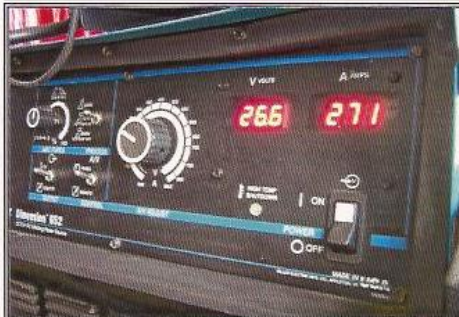
TOMA DE LECTURAS DEL REGIMEN DE SOLDADURA DURANTE LA EJECUCION DE LA UNION
