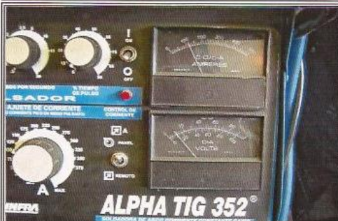
LACTURA Y REGISTRO DE LOS PARAMETROS DE SOLDADURA (AMPERAJE/VOLTAJE)
