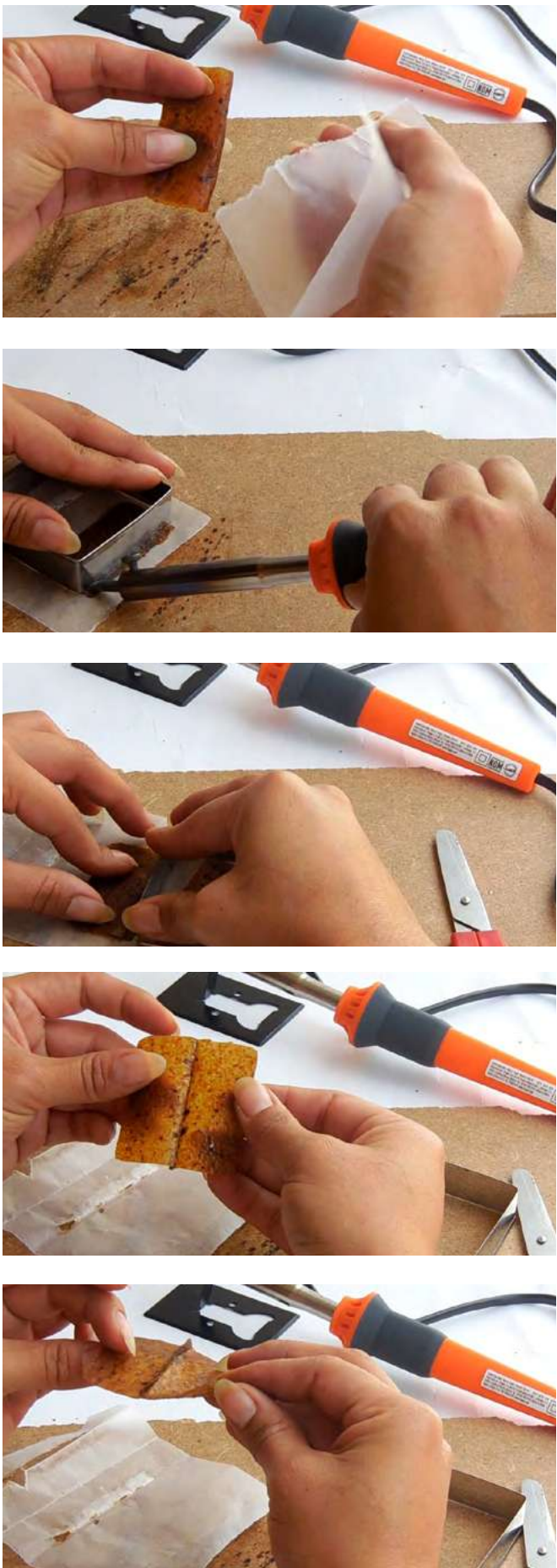
FIGURA 428 PROCEDIMIENTO PARA PEGADO TÉRMICO.
