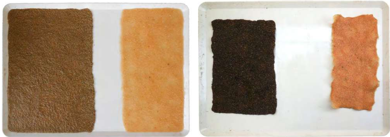
FIGURA 420 EJEMPLO CONTRACCIÓN DE BIOPLÁSTICO DE CÁSCARA DE MANGO Y ALBEDO DE TORONJA
