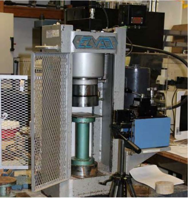
FIGURA 401 PRUEBA DE COMPRESIÓN SIMPLE: LUGAR Y EQUIPO.
