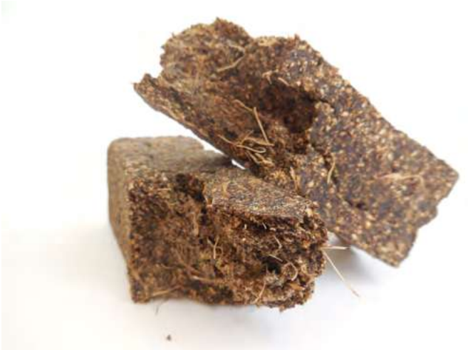
FIGURA 357 RESULTADO FINAL DE MUESTRAS DESPUÉS DE LA PRUEBA DE RESISTENCIA A FUERZA MANUAL.
