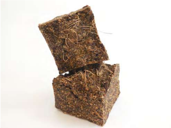
FIGURA 357 RESULTADO FINAL DE MUESTRAS DESPUÉS DE LA PRUEBA DE RESISTENCIA A FUERZA MANUAL.
