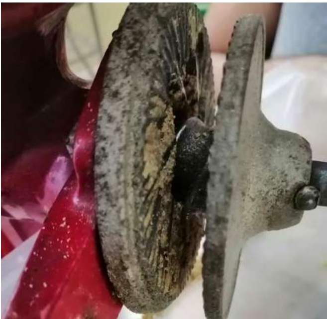
FIGURA 386 ALOJAMIENTO DE MATERIAL EN ESTRÍAS DEL MOLINO.
