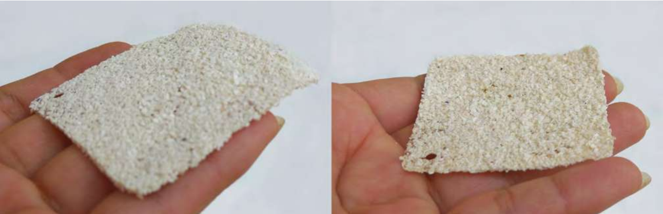
FIGURA 421 EJEMPLO TEXTURA EN CARA POSTERIOR SEMI-LISA Y CARA FRONTAL RUGOSA.
