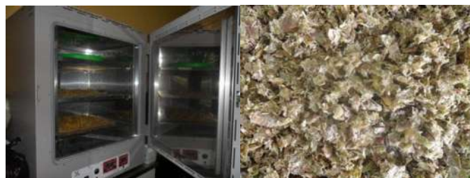
Fig. A. 2. Secado del membrillo en la estufa a 60 °C.
