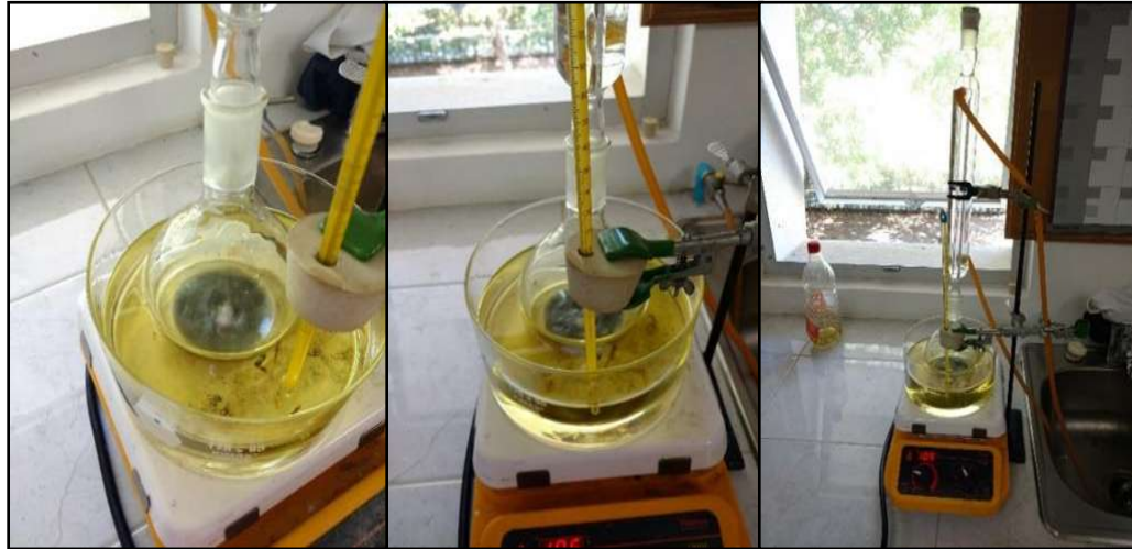
Figura 13a. Sistema de impregnación húmeda para la obtención de \text{CeO}_2/\gamma\text{-Bi}_2\text{Mo}_x\text{Ru}_{1-x}\text{O}_6 .
