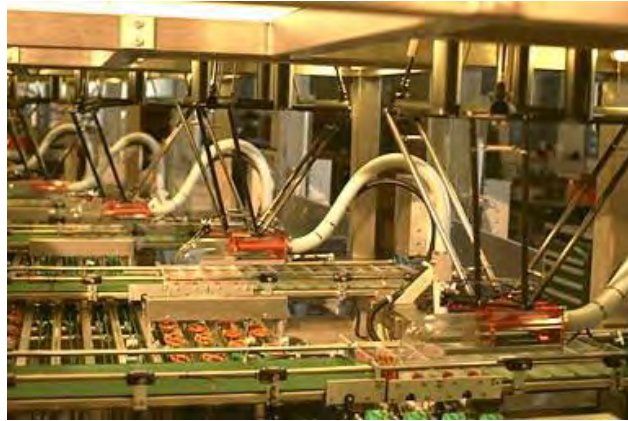
Figura 4 Instalación Line-Placer para el empaquetamiento de bocadillos (Bretzels) [5].
