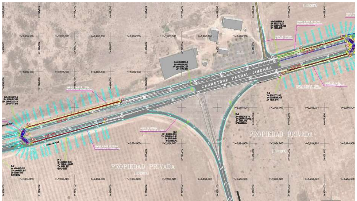
Figura 49. Alternativa de solución mediante dos PIV (Elaboración Propia)
