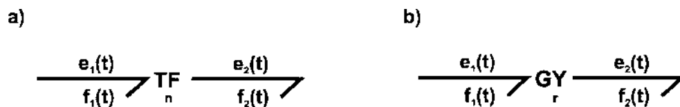
Figura 2.3 Puerto 2, a) Transformador ideal – b) Gyrador ideal.
