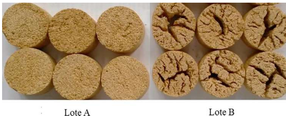
Figura 2.12. Corte transversal de las briquetas. Lote A: se observa mejor compactación del material y un acabado uniforme; Lote B: Se observan espacios vacíos en el interior, menor compactación y apariencia no uniforme.
