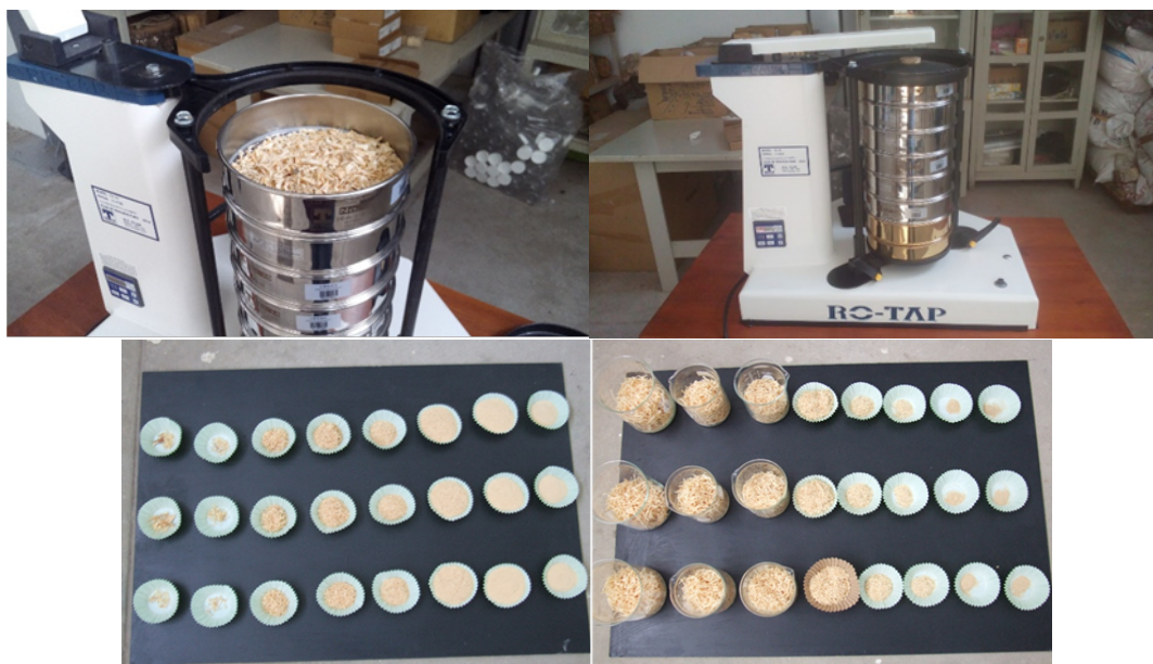
Figura 4.7. Tamiz vibrante. Para este caso se detalló una serie de tamices de malla metálica de especificaciones y tamaños normalizados como los que se muestra en la Tabla 4.1
