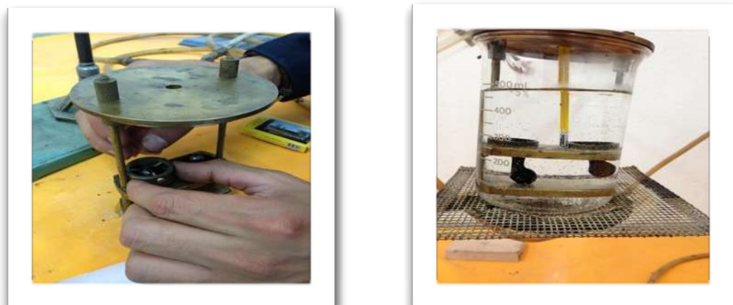
Imagen 3.16 : Colocacionde esferas sobre los anillos de latón
