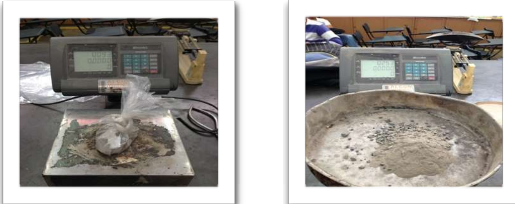
Imagen 4.2: Obtención del peso de cada material
