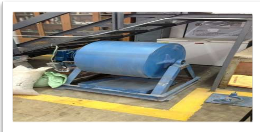
Imagen 3.36: Colocación del material y esferas de acero en la máquina de los ángeles
