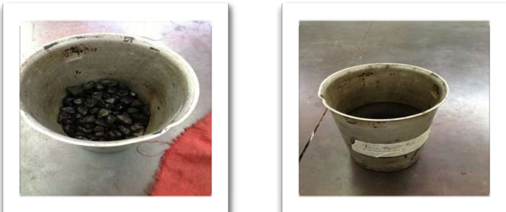
Imagen 3.42: Saturación del material durante 24 horas
