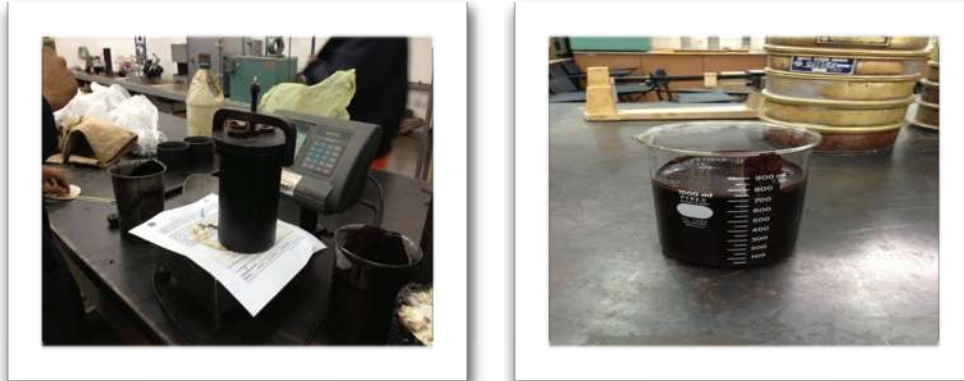
Imagen 3.4 : Pesado del alambique y accesorios
