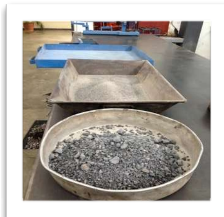
Imagen 3.37: Cribado del material triturado por la máquina de los ángeles
