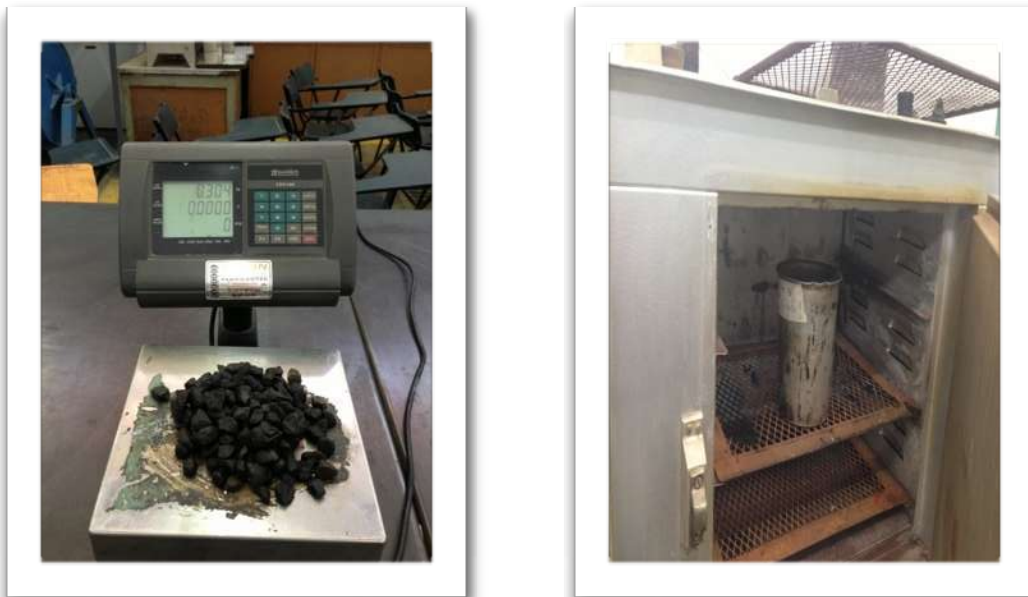
Imagen 3.43: Pesado y secado del material pétreo
