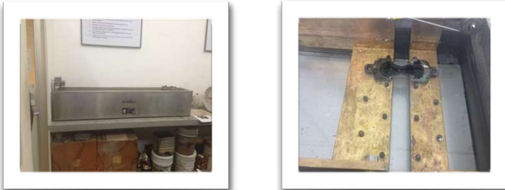
Imagen 3.20: Colocación de la briqueta en el ductilómetro
