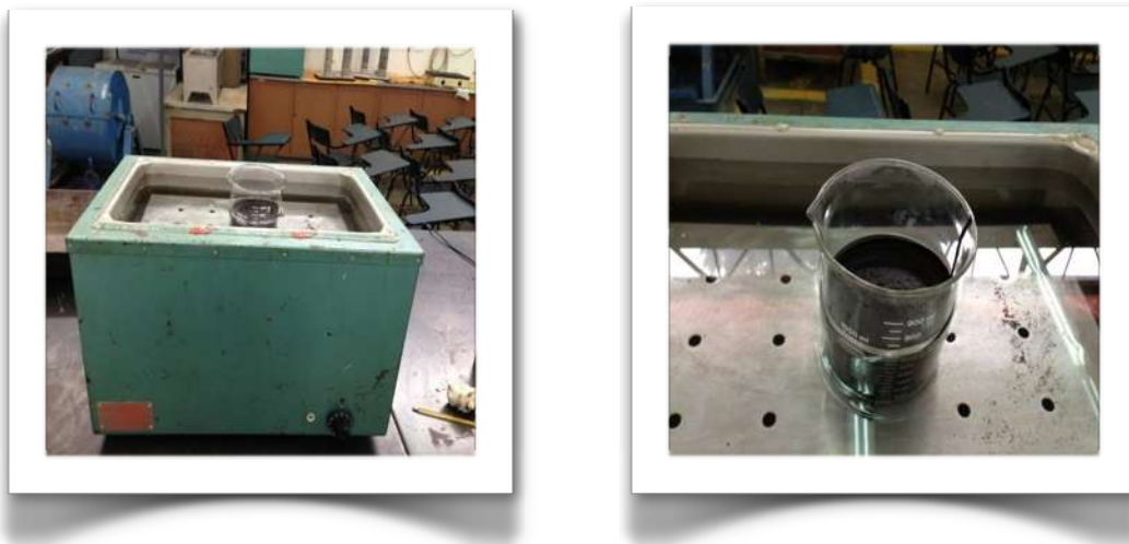
Imagen 3.11 : Colocacionde la emulsión asfaltica en baño maría
