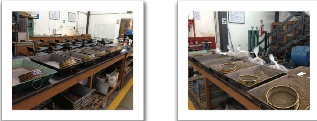
Imagen 3.30: Cribado del material.
