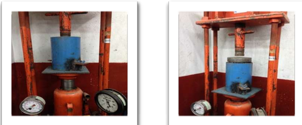
Imagen 4.14: Compactación del material con la prensa hidráulica
