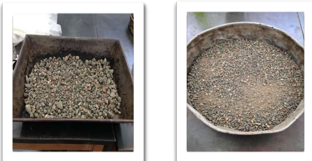
Imagen 4.5: Colocación del material en bandejas dependiendo de su tamaño
