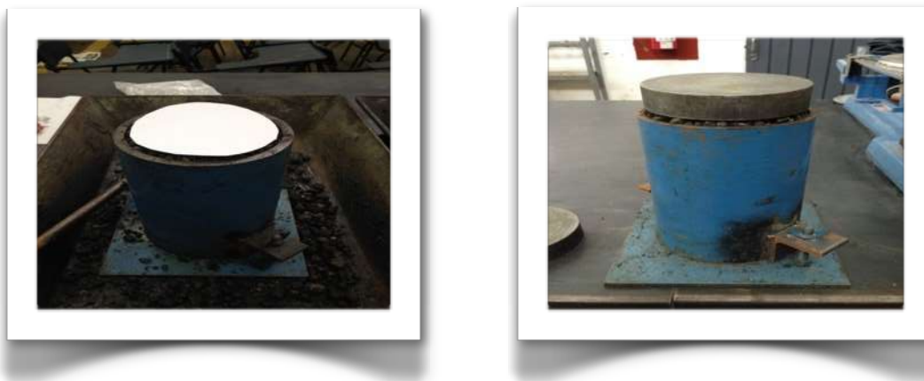
Imagen 4.13: Preparación previa a compactación
