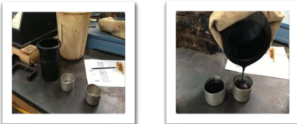
Imagen 3.7 : Llenado de las cápsulas con el residuo de la destilación
