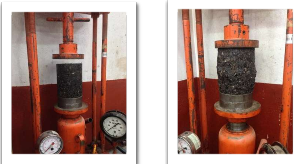
Imagen 4.17: Carga de compresión axial al espécimen
