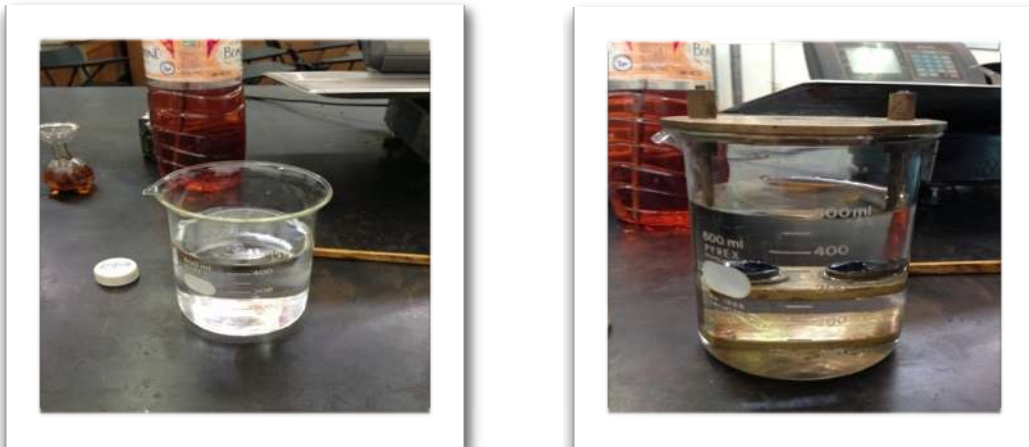
Imagen 3.15 : Colocacion de los anillos dentro del baso de precipitados
