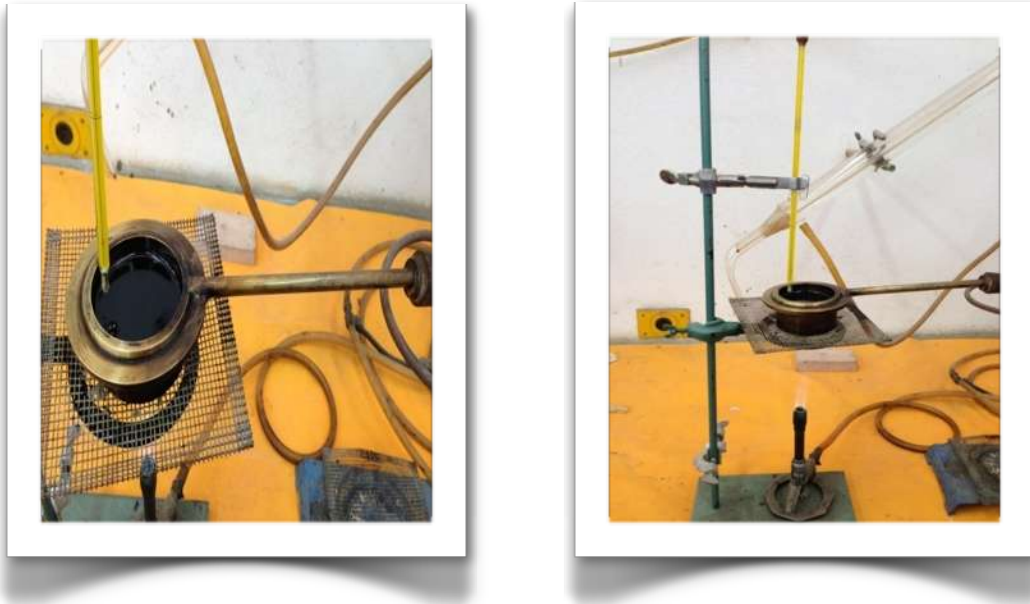
Imagen 3.18 : Incremento de la temperatura en la copa de Cleveland
