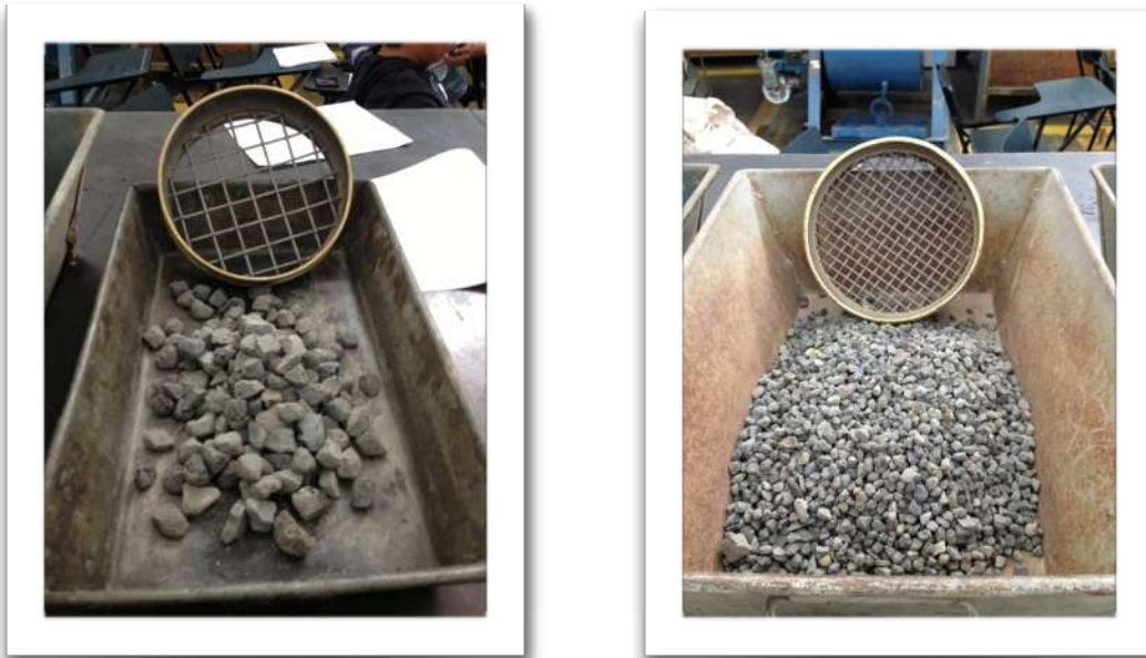
Imagen 4.1: Cribado de material
