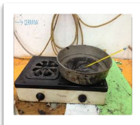
Imagen 3.8 : Colocacion de la capsula en agua a 25 °C durante 2 horas
