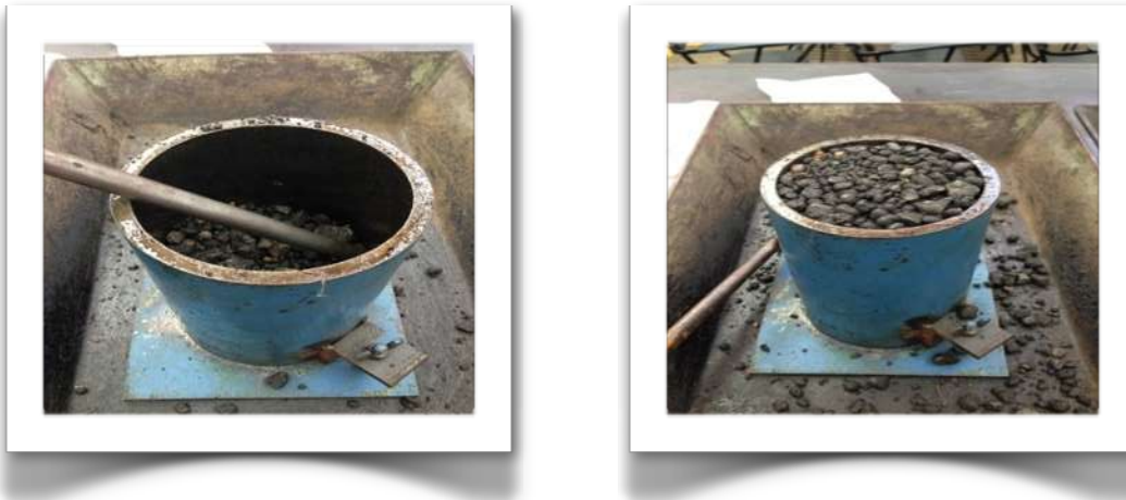
Imagen 4.12: Colocación del material dentro del molde
