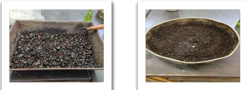
Imagen 4.6: Colocación del agua al agregado pétreo
