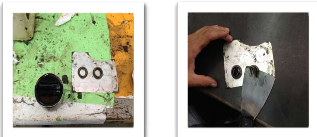
Figura 3.14: Llenado y enrazado de anillos de latón
