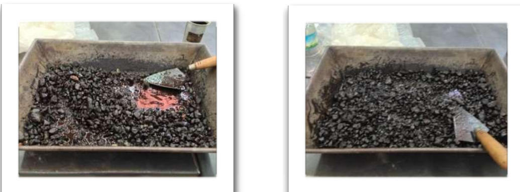
Imagen 4.7: Colocación de la emulsión asfáltica en el material grueso
