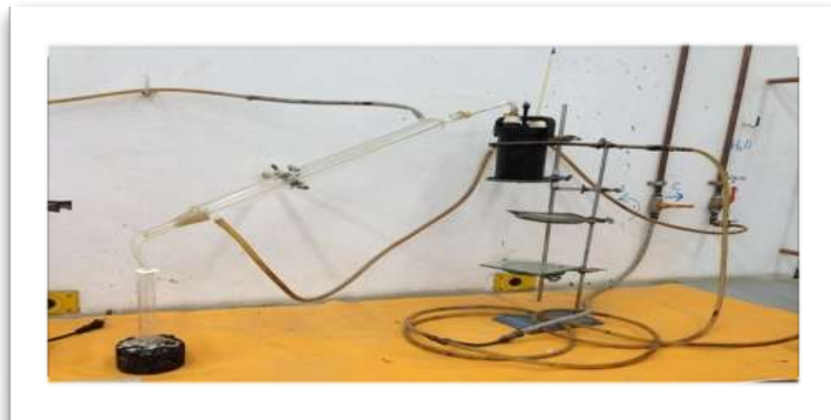
Imagen 3.5 : Colocación del alambique para prueba de destilación
