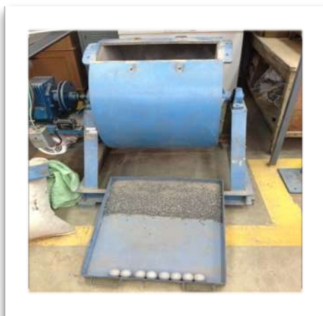
Imagen 3.37: Cribado del material triturado por la máquina de los ángeles
