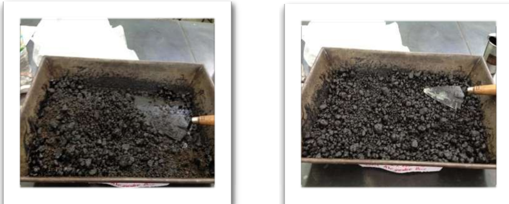
Imagen 4.8: Se agregara la parte fina al material grueso
