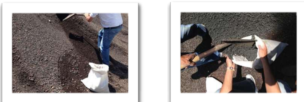
Imagen 3.28 : Muestreo del material pétreo
