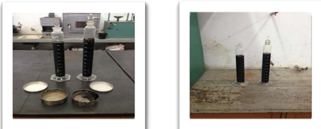
Imagen 3.22 : Llenado de probetas con emulsion asfaltica
