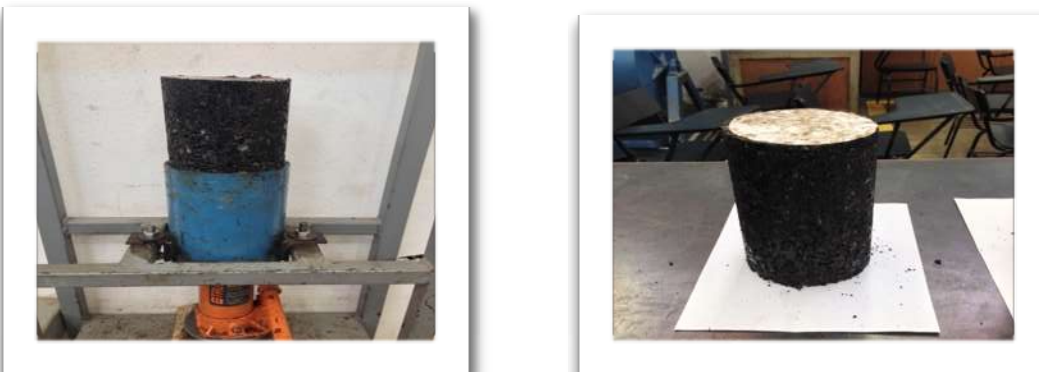
Imagen 4.16: Extracción del espécimen del molde
