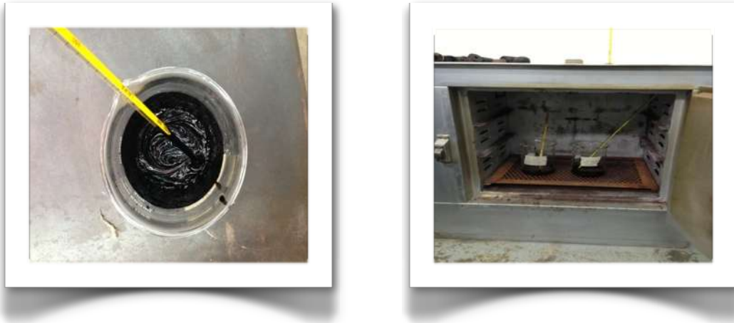
Imagen 3.24: Colocacion de las muestras en el horno por 2 horas
