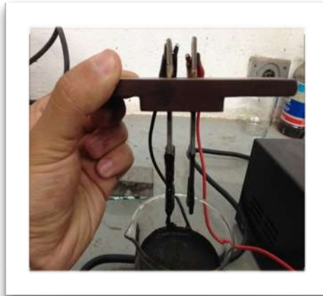
Imagen 3.3 : Identificación de carga de la emulsión asfáltica
