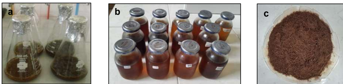
Figura 4.11 a) Bagazo antes (izquierda) y después (derecha) de la hidrólisis ácida, b) Hidrolizados ácidos, c) Sólido residual.
