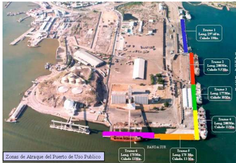
Fig. 3. Zonas que componen un puerto.
