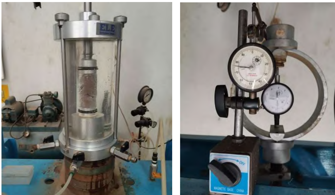
Figura 4.30. Cámara triaxial y manómetro y válvulas para la presión de confinamiento. Fotografías: (M. Ruiz-Mendoza, 2020).
