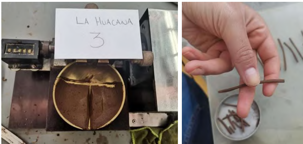
Figura 4.21. Procedimiento del ensayo de los límites de consistencia: (a) Determinación del límite líquido mediante la copa de Casagrande; (b) Formación de los cilindros para el cálculo del límite plástico. Fotografías: (M. Ruiz-Mendoza, 2020).
