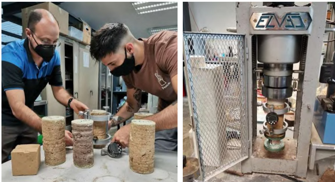
Figura 4.33. Preparación del equipo y las muestras para el ensayo de determinación del módulo de elasticidad estático. Fotografías: (M. Ruiz-Mendoza, 2020).
