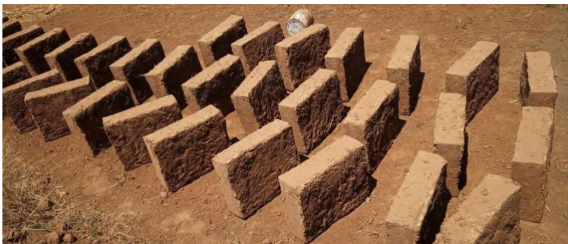
Figura 1.13. Producción y secado de adobes en Erongarícuaro, Michoacán, México. Fotografía: (A. Sánchez-Calvillo, 2021).
