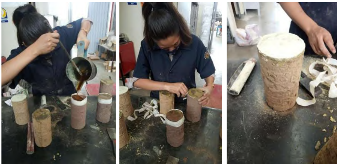
Figura 4.26. Proceso de cabeceado de los cilindros de la Huacana y Santa Cruz de Morelos. Fotografías: (A. Sánchez-Calvillo, 2020).
