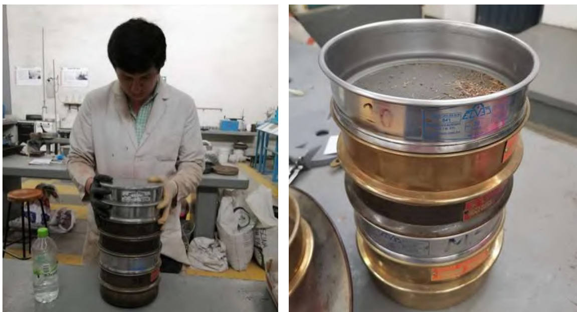
Figura 4.18. Instrumental de tamices ASTM y procedimiento de cribado. Fotografías: (A. Sánchez-Calvillo, 2019; M. Ruiz-Mendoza, 2020).
