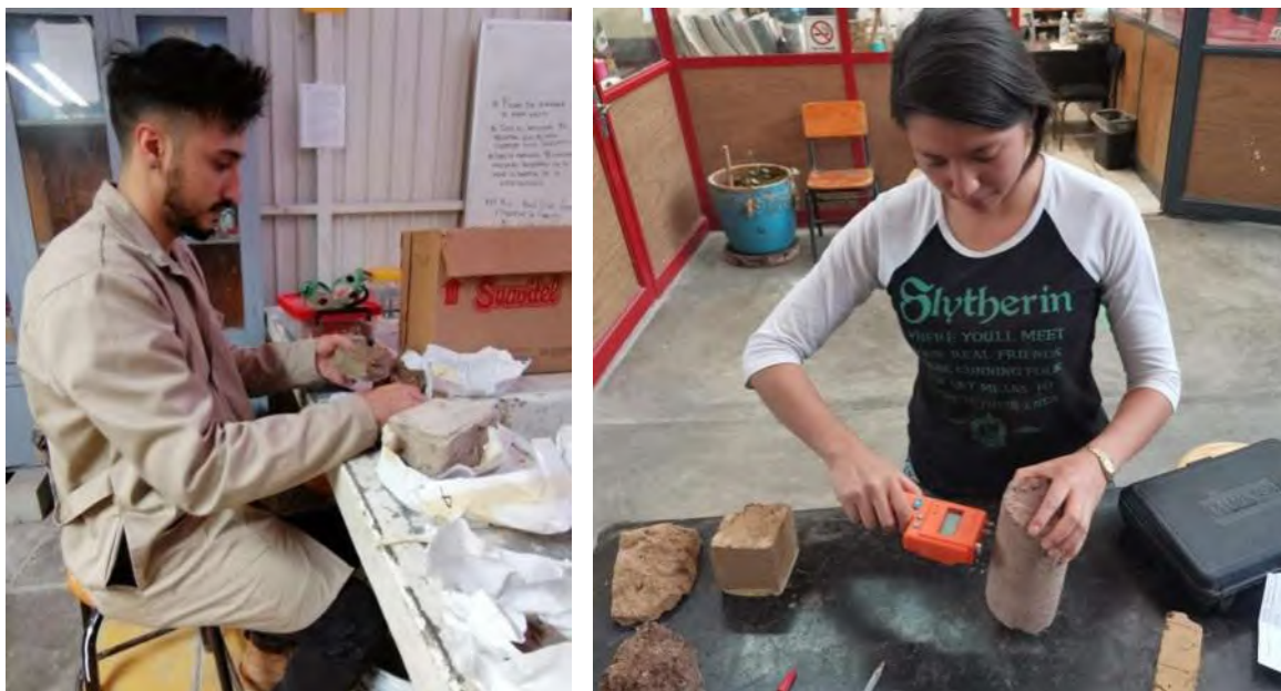
Figura 4.3. Proceso de caracterización de los adobes en el Laboratorio de Materiales “Ing. Luis Silva Ruelas”. Fotografías: (D. Preciado-Villicaña, 2019; A. Sánchez-Calvillo, 2020).
