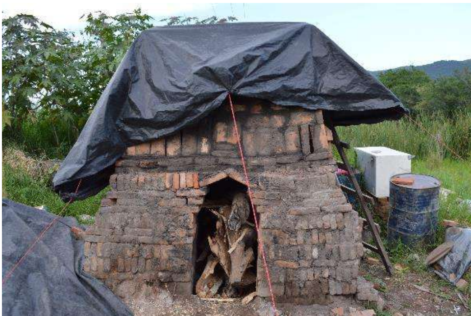
Figura 2.48. Horno tabiquero con material de desecho usado como combustible. Fotografía: (A. Sánchez-Calvillo y E. G. Navarro-Mendoza, 2018).
