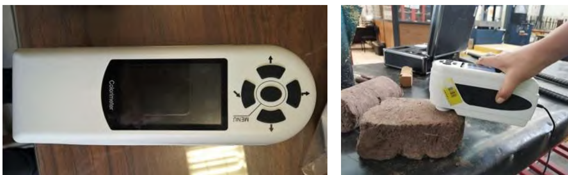
Figura 4.17. Equipo y proceso de medición del color (a) Colorímetro CLRM-200; (b) Lecturas con el equipo colorimétrico en adobes de Tierra Caliente. Fotografías: (A. Sánchez-Calvillo, 2018; M. Ruiz-Mendoza, 2020).
