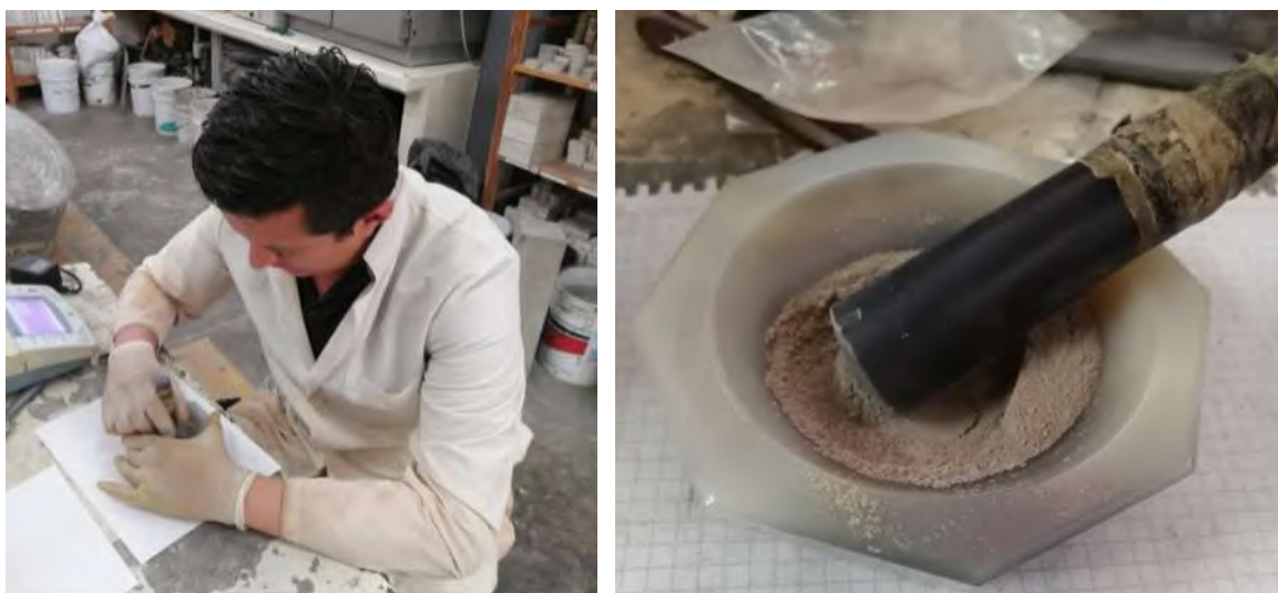
Figura 4.12. Proceso de trituración de las muestras en polvo. Fotografías: (A. Sánchez-Calvillo, 2019).
