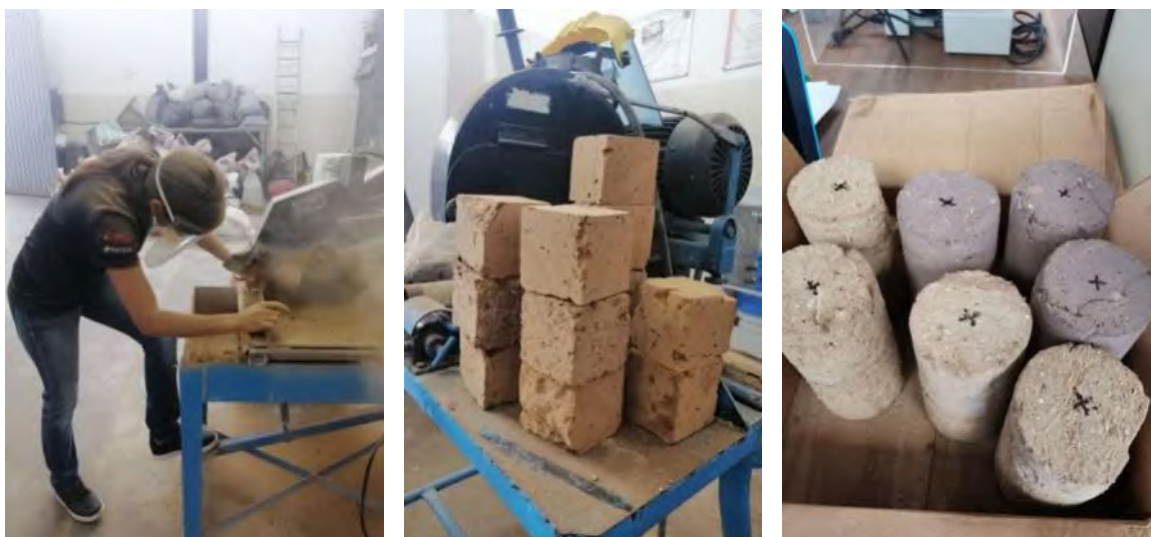
Figura 4.10. Labrado y preparación de las muestras de la Huacana y Santa Cruz de Morelos. Fotografías: (M. Ruiz-Mendoza, 2020).
