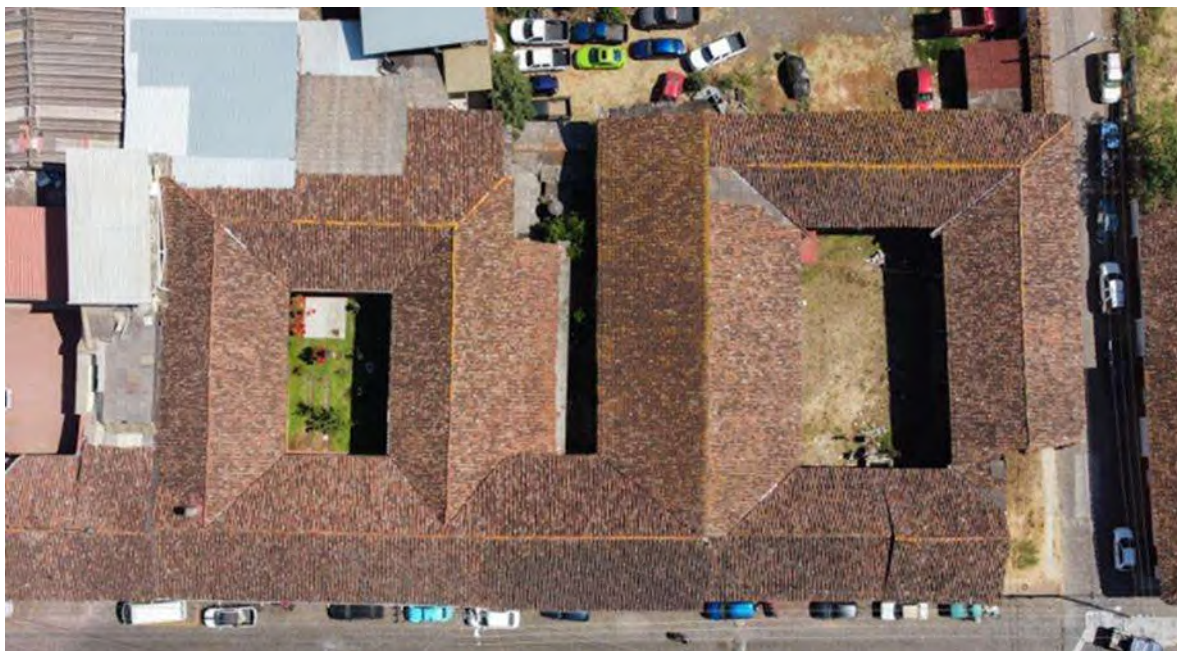
Figura 3.23. Toma aérea de dron del centro de Ario de Rosales. Pueden observarse los sistemas originales de cubierta y la incipiente sustitución en algunas áreas. Fotografía de dron: (A. Solís-Sánchez, 2021)
