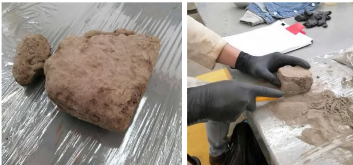
Figura 4.11. Labrado y preparación de las muestras de Jojutla de Juárez. Fotografías: (A. Sánchez-Calvillo, 2019).
