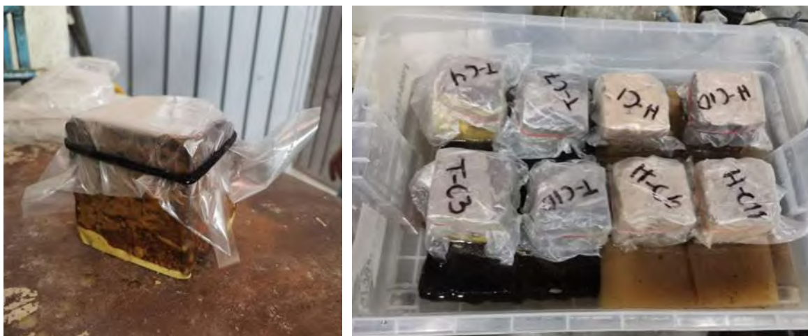
Figura 4.35. Procedimiento del ensayo de sortividad o absorción capilar. Fotografías: (M. Ruiz-Mendoza, 2021).
