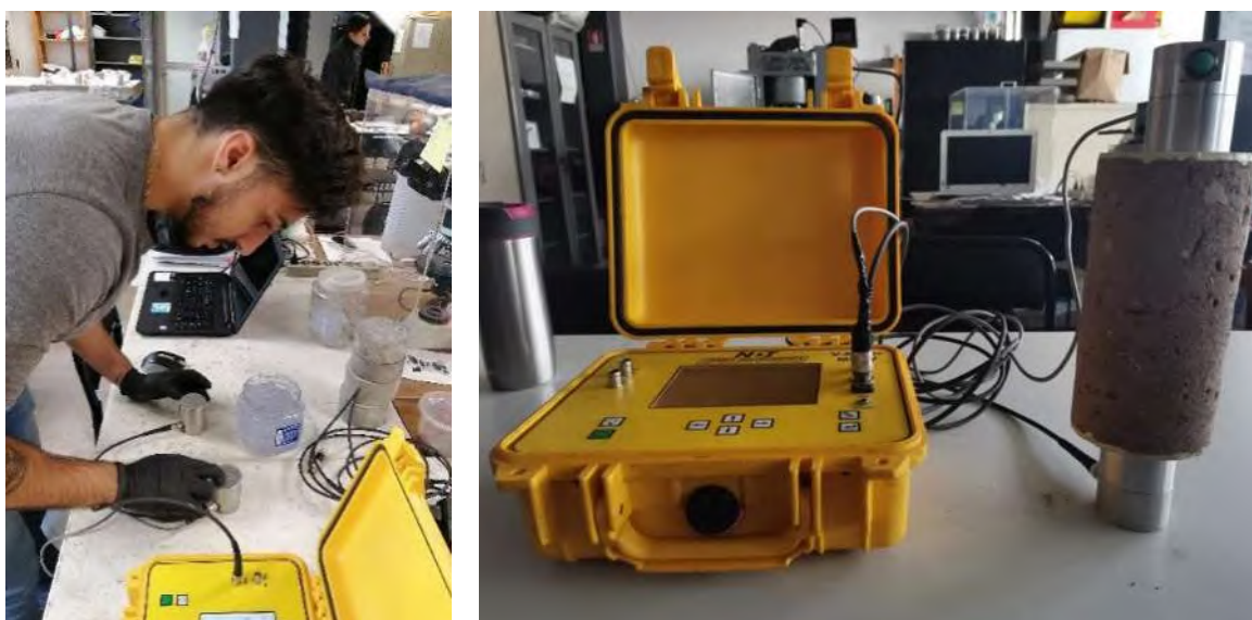
Figura 4.32. Equipo y procedimiento de ensayo de la velocidad de pulso ultrasónico. Fotografías: (A. Sánchez-Calvillo, 2019; M. Ruiz-Mendoza, 2021).
