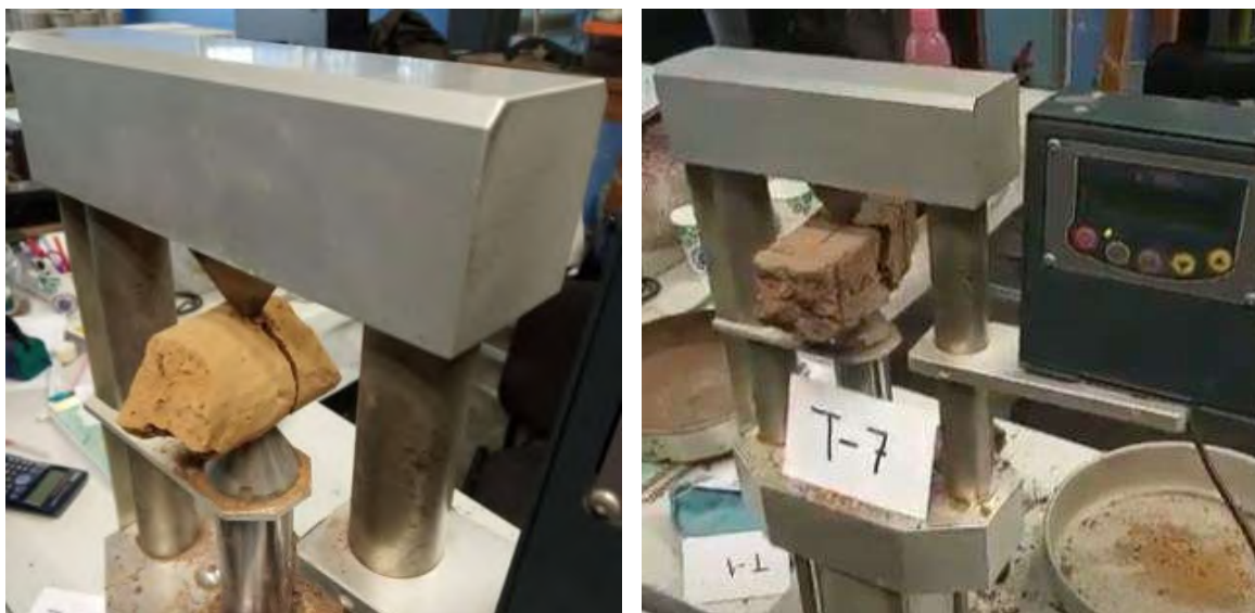
Figura 4.29. Modo de falla de los especímenes durante el ensayo point load. Fotografías: (M. Ruiz-Mendoza, 2020).
