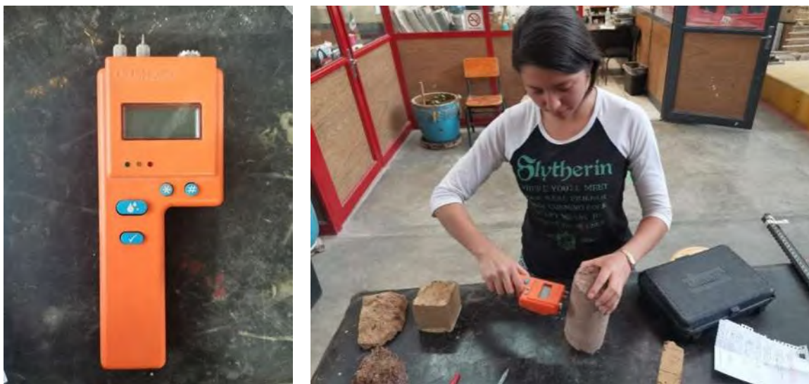
Figura 4.14. Equipo de medición de la humedad y procedimiento de ensayo. Fotografías: (A. Sánchez-Calvillo, 2020).
