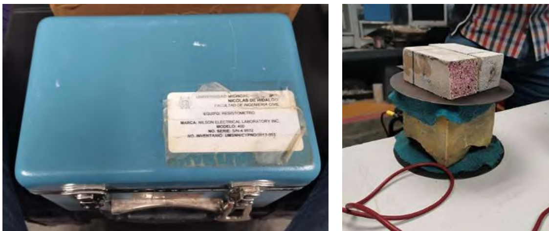
Figura 4.15. Ensayo de resistividad eléctrica. (a) Equipo de medición; (b) Procedimiento de ensayo en muestra de adobe de Tierra Caliente. Fotografías: (M. Ruiz-Mendoza, 2021).
