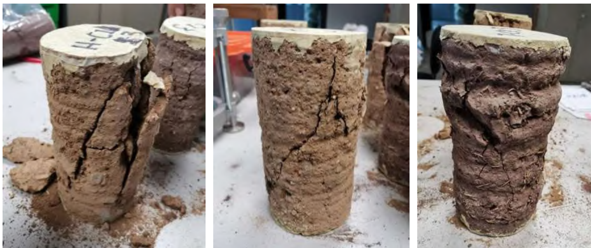
Figura 4.34. Falla de los especímenes de adobe tras el ensayo de esfuerzo-deformación. Fotografías: M. Ruiz-Mendoza, 2020).
