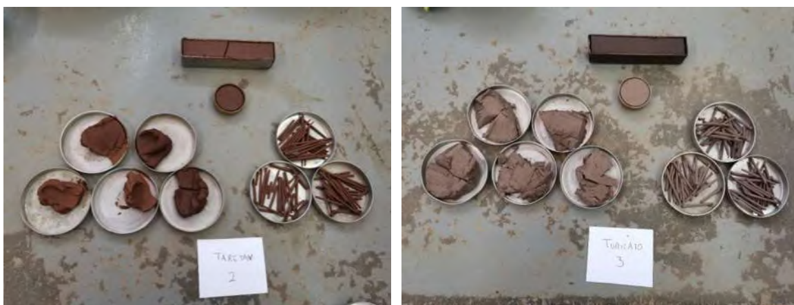
Figura 4.22. Material resultante del límite líquido, límite plástico, contracción lineal y contracción volumétrica. Muestras de Taretan y Santa Cruz de Morelos. Fotografías: (M. Ruiz-Mendoza, 2020).
