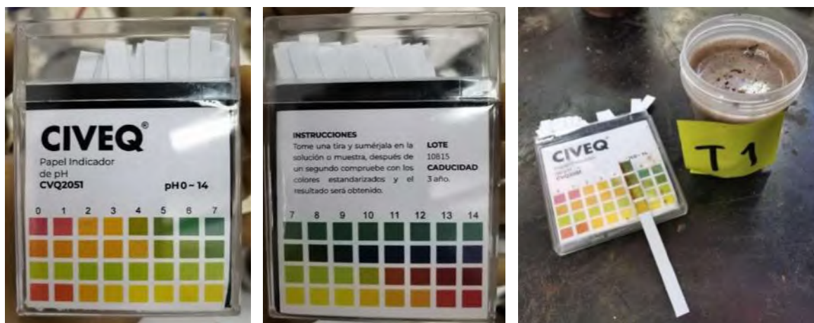
Figura 4.24. Equipo y proceso de medición del potencial de hidrógeno con tiras reactivas. Fotografías: (D Preciado-Villicaña, 2019).
