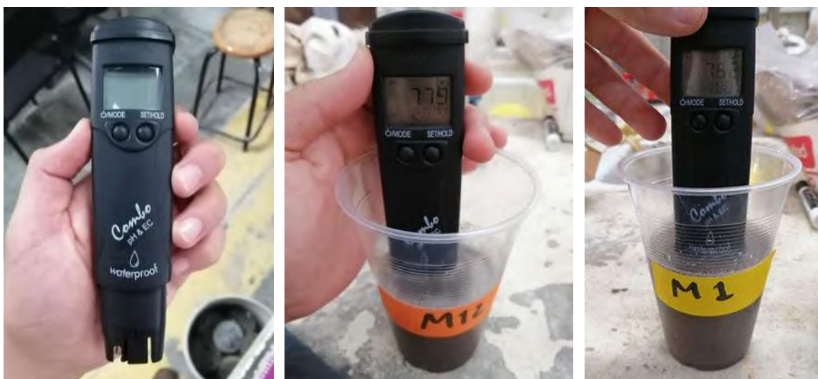
Figura 4.23. Equipo y proceso de lectura del potencial de hidrógeno con medidor de pH digital. Fotografías: (D. Preciado-Villicaña, 2019).
