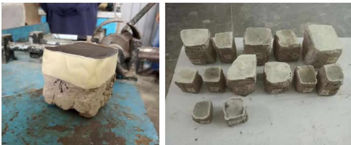
Figura 4.25. Cabeceado de las muestras de Jojutla de Juárez. Fotografías: (A. Sánchez-Calvillo, 2019).
