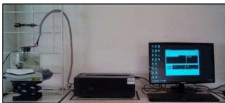
Figura 15.- Arreglo para el sistema de anodización electroquímica.
