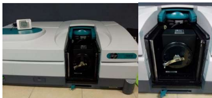
Figura 7.- Espectrómetro UV-Vis con esfera integradora.
