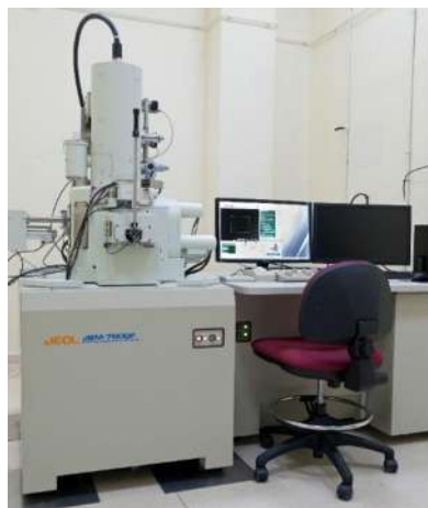
Figura 5.- Microscopio Electrónico de Barrido JEOL JSM 7600F.
