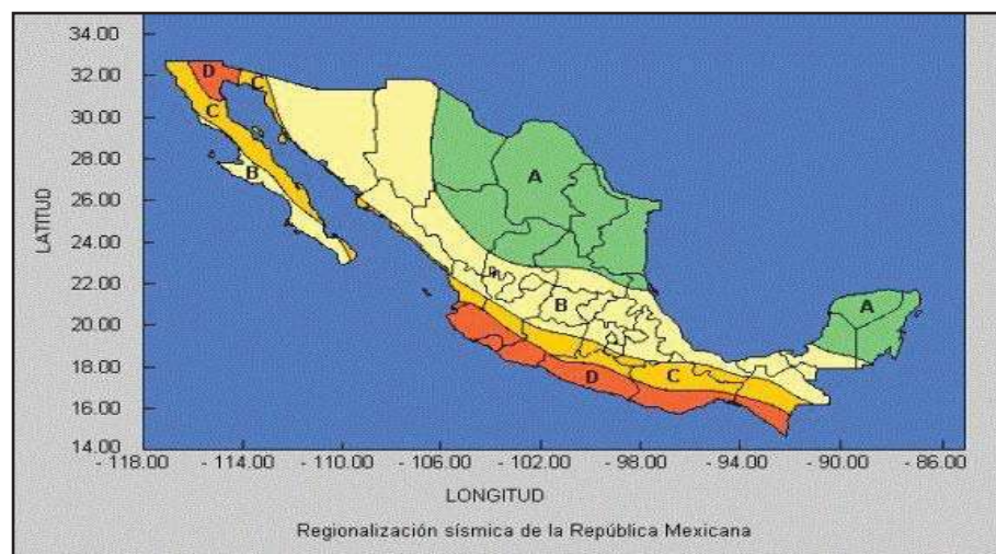
Figura 6.- Mapa de regionalización sísmica de la República Mexicana, tomado del Manual de Diseño de Obras Civiles de la Comisión Federal de Electricidad (1993).
