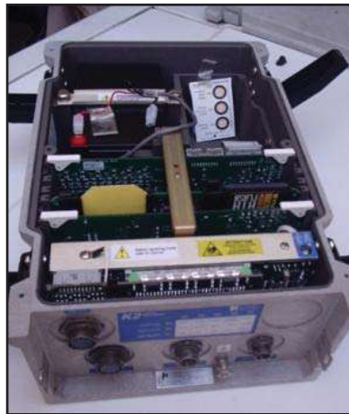
Figura 22.- Vista del interior del acelerógrafo Altus Digital Recorder, modelo K2, marca KINEMATRICS.
