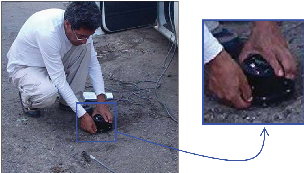
Figura 30.- Colocación del sensor el cual tiene grabado un eje de coordenadas que se orienta hacia el norte el correspondiente al eje X, a demás se nivela por medio de tres tornillos ajustadores basándose en el nivel de burbuja integrado.
