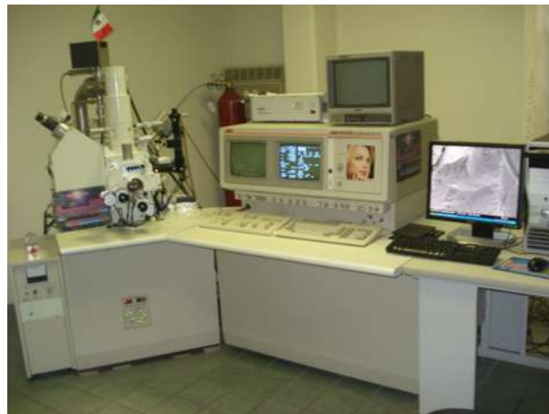
Figura 2.8 Microscopio electrónico de barrido JEOL JSM-6400.
