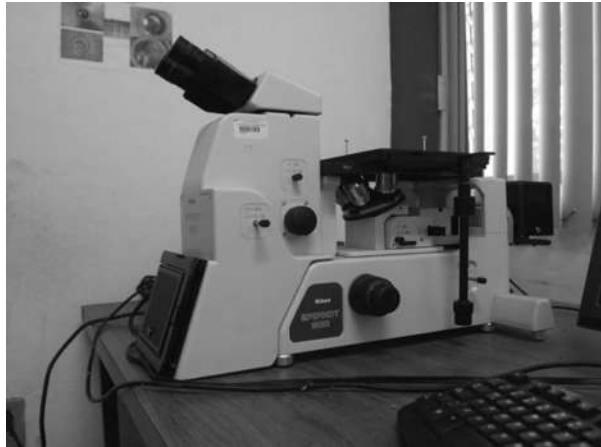
Figura 2.4 Microscopio óptico Invertido NIKON EPIPHOT 300.
