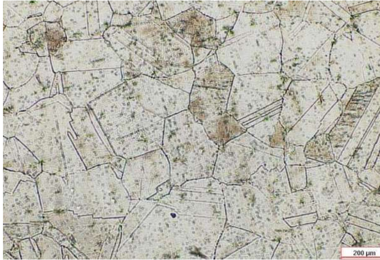
Figura 1.2. Microestructura del acero TWIP con tratamiento térmico de solubilizado después de la laminación en caliente a 1200°C [8].
