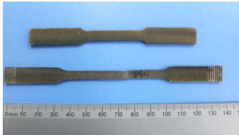
Figura 1.4. Probeta P1 antes y después del ensayo de tensión, con tratamiento térmico de solubilizado de 1200°C [8].
