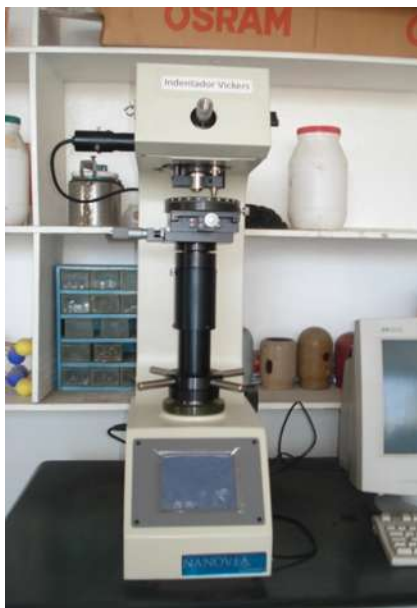
Figura 2.5 Durómetro Nanovea automático.
