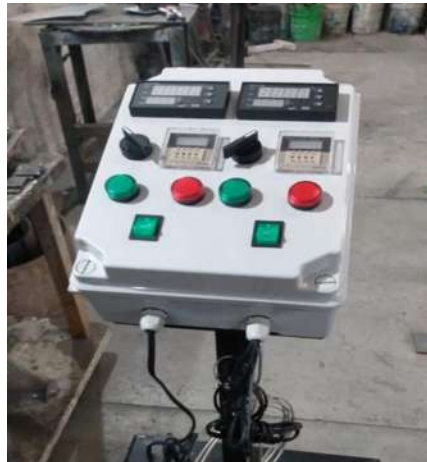
Figura 6.9. Tablero de control
