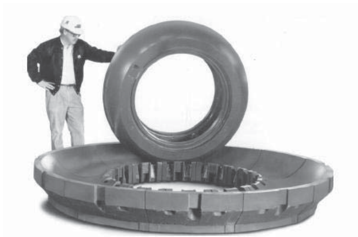
Figura 2.7 Rueda y segmento de la guía sujeta a desgaste de hierro blanco alto-cromo en una pulverizadora de carbón [2].
