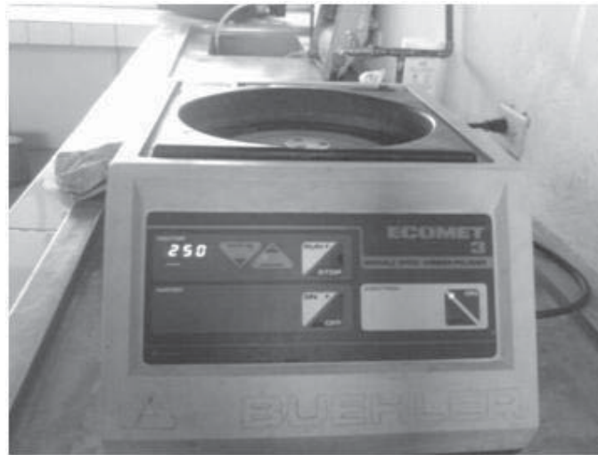
Figura 3.5 Pulidora Marca Buehler modelo Ecomet 3 utilizada para el pulido de las muestras con paño de nylon y pasta de diamante.
