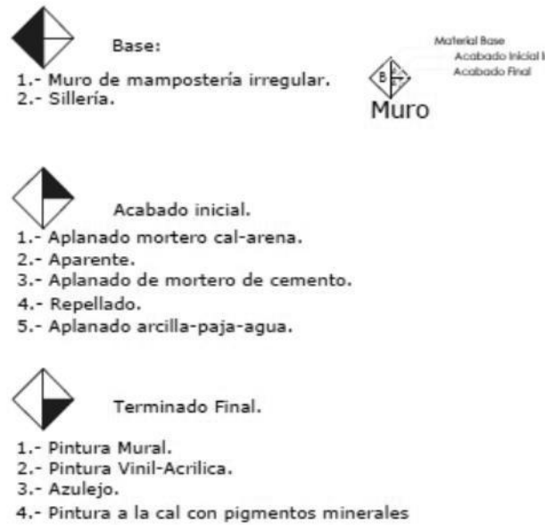
Figura 31: Simbología empleada para el levantamiento de materiales y sistemas constructivos 87
