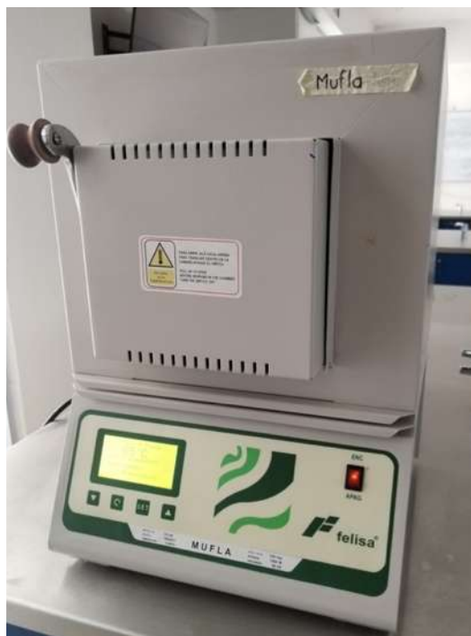
Figura 18. Mufla de síntesis de la hidrotalcita híbrida..
