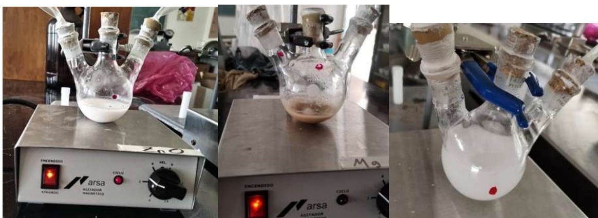
Figura 17. Sistema de agitación en presencia de Ar.
