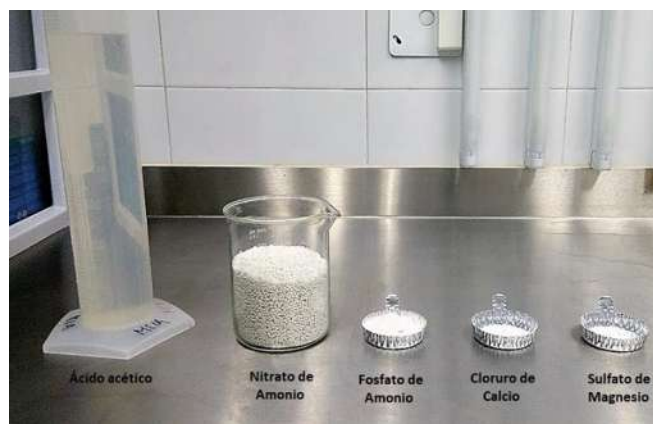
Figura 4.4 Reactivos empleados para la elaboración del sustrato sintético para una relación C:N= 20
