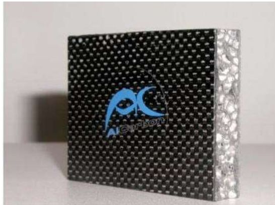
Figura 2.8 Estructura sándwich formada de dos placas de aluminio de 5 mm de espesor y un centro de espuma de aluminio de 30 mm [21].
