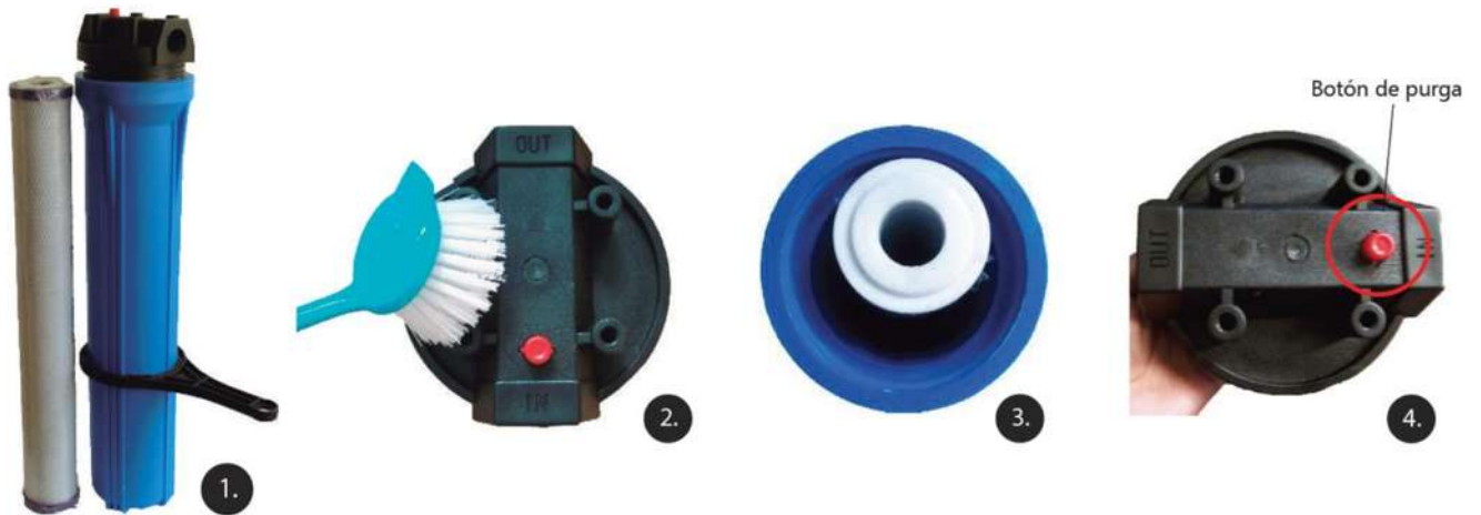
Figura 43. Mantenimiento de filtro de carbón activado (fuente: Isla Urbana, 2018).
